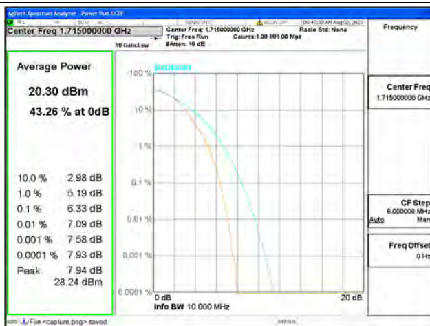
B4 / 10MHz / Low CH / 16QAM
