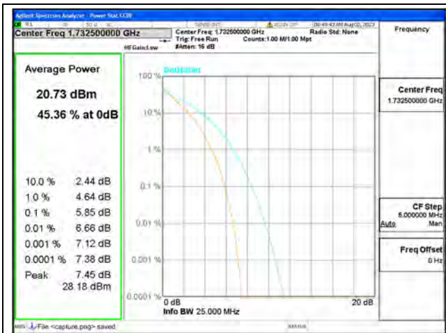
B4 / 20MHz / Mid CH / QPSK
