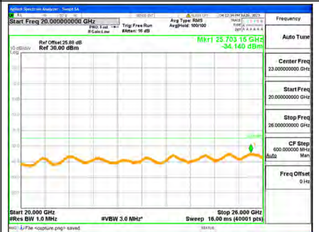
B7-20G-26G / 20MHz / Mid CH / QPSK
