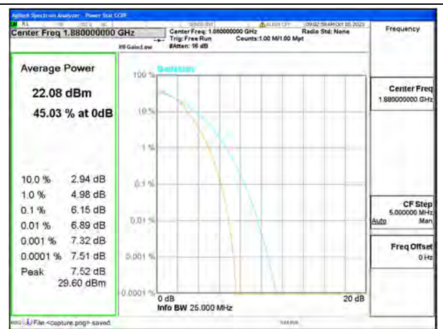
B2 / 20MHz / Mid CH / 16QAM
