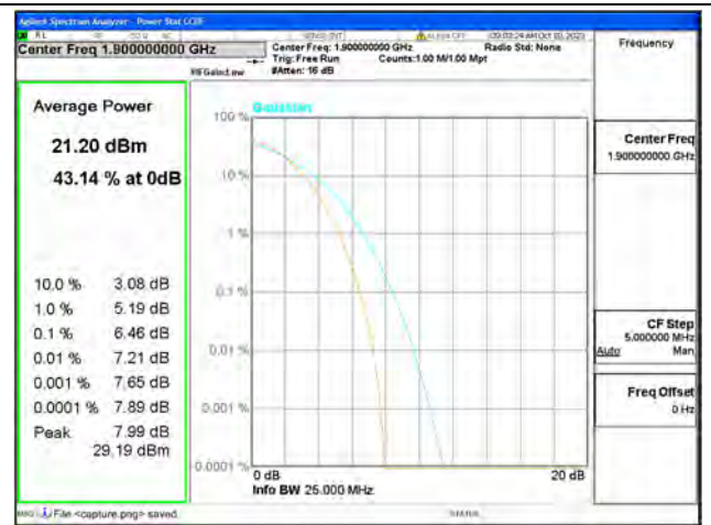
B2 / 20MHz / High CH / 64QAM
