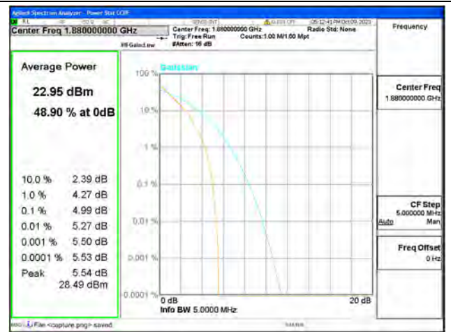
B2 / 1.4MHz / Mid CH / QPSK
