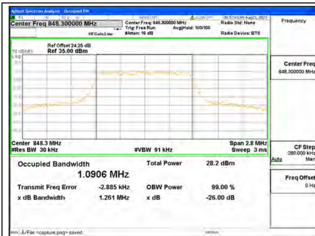
B5 / 1.4MHz / QPSK/ High CH
