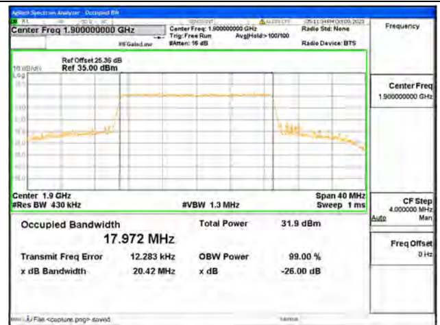
B2 / 20MHz / QPSK / High CH
