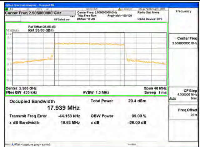
B41 / 20MHz / 64QAM/ Low CH
