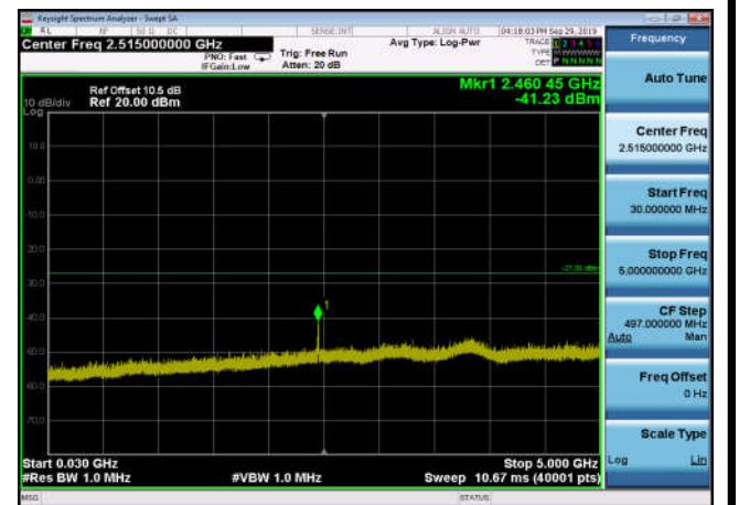
U-NII-1 ,Plot 2,30MHz~5000MHz-802.11n (40MHz),5230MHz,Ant1
