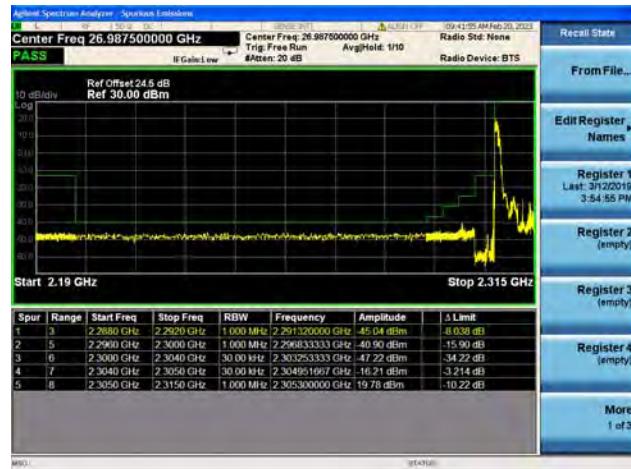
Band40 / 5MHz / Low CH / QPSK / 1 RB
