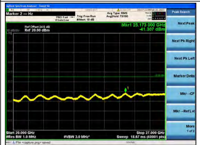
Band41(2535~2655)-20G-27G / 5MHz / Mid CH / 16QAM
