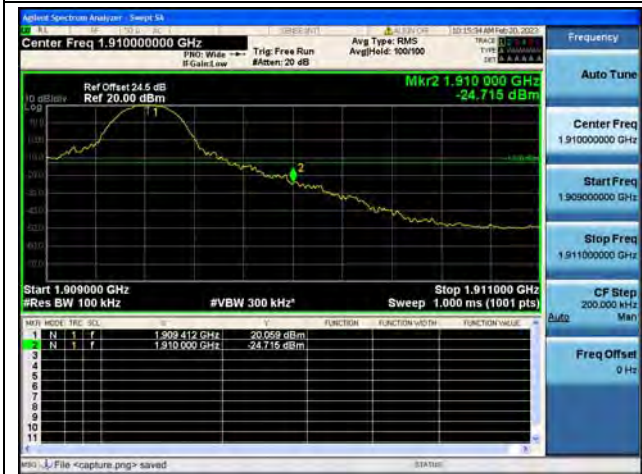
Band2 / 10MHz / High CH / QPSK / 1 RB
