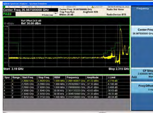
Band40 / 10MHz / Low CH / QPSK / 1 RB
