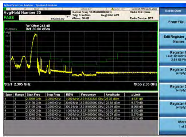
Band40 / 10MHz / High CH / QPSK / 1 RB
