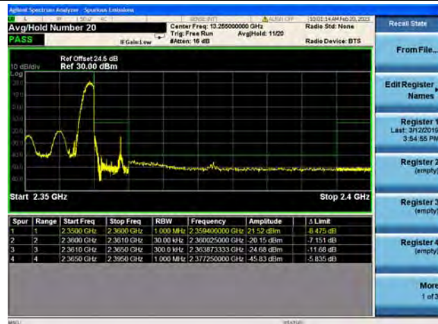
Band40 / 10MHz / High CH / QPSK / 1 RB
