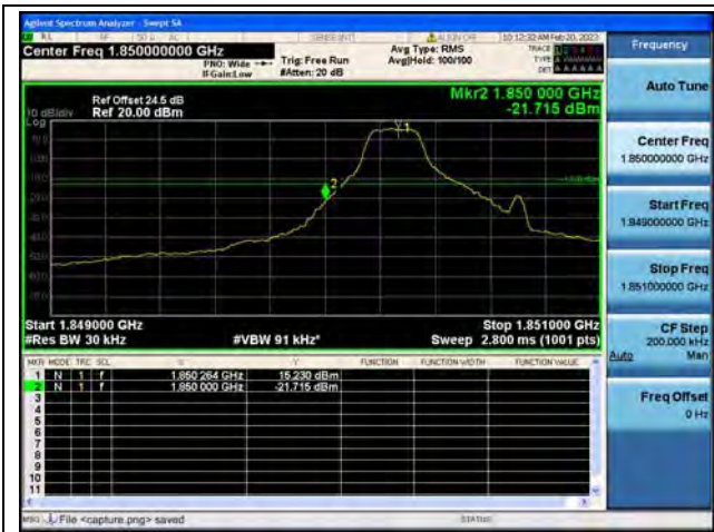
Band2 / 1.4MHz / Low CH / QPSK / 1 RB
