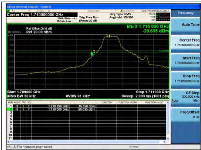
Band4 / 1.4MHz / Low CH / QPSK / 1 RB
