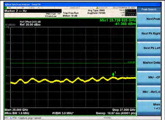
Band41(2535~2655)-20G-27G / 20MHz / Low CH / 16QAM
