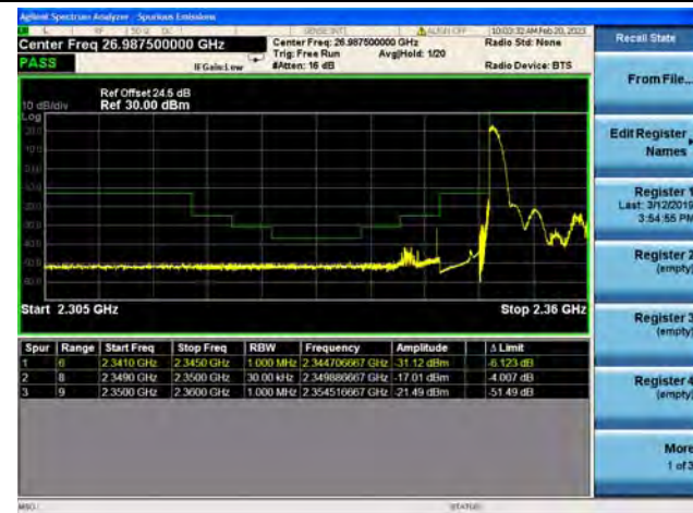
Band40 / 5MHz / Low CH / QPSK / 1 RB
