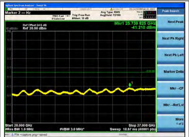
Band41(2535~2655)-20G-27G / 15MHz / Mid CH / QPSK
