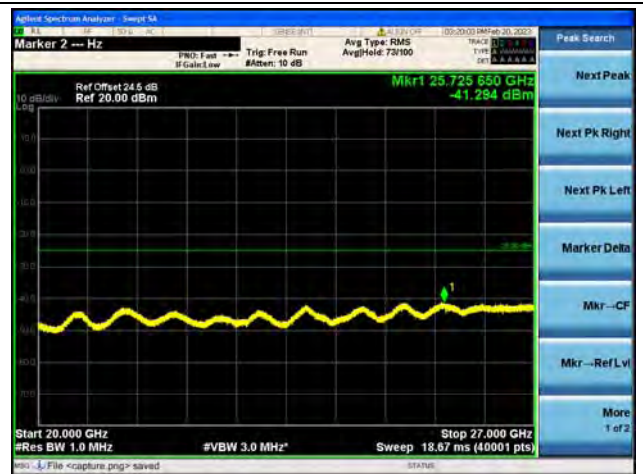
Band41(2535~2655)-20G-27G / 20MHz / High CH / QPSK
