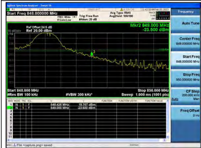
Band5 / 10MHz / High CH / QPSK / 1 RB
