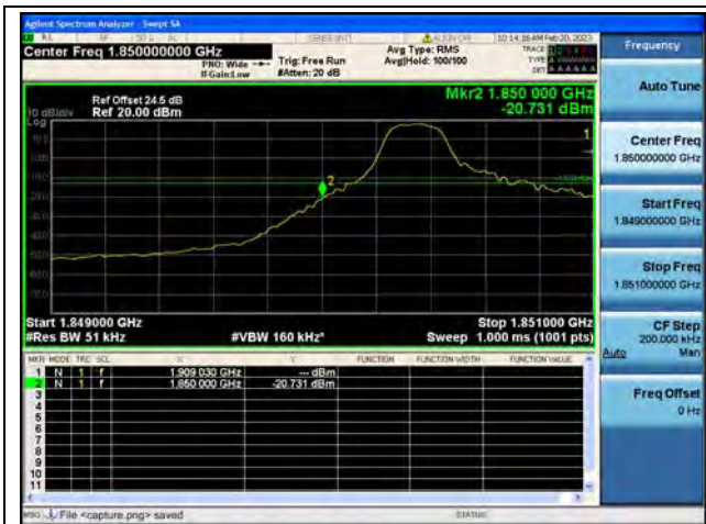
Band2 / 5MHz / Low CH / QPSK / 1 RB
