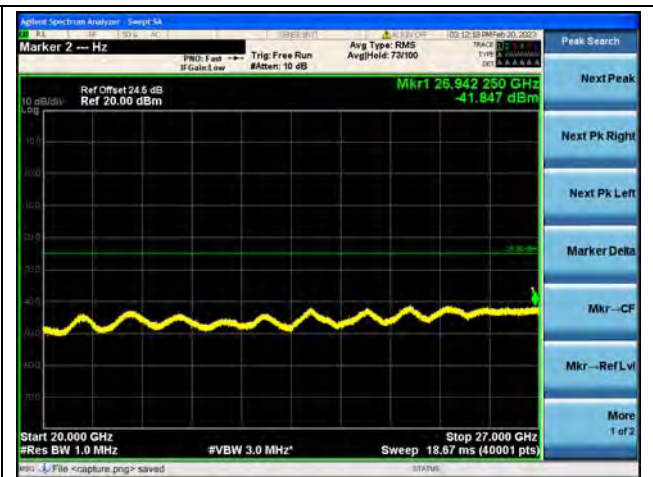
Band41(2535~2655)-20G-27G / 10MHz / High CH / QPSK
