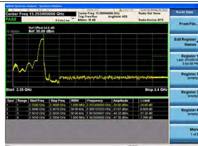
Band40 / 5MHz / High CH / QPSK / 1 RB
