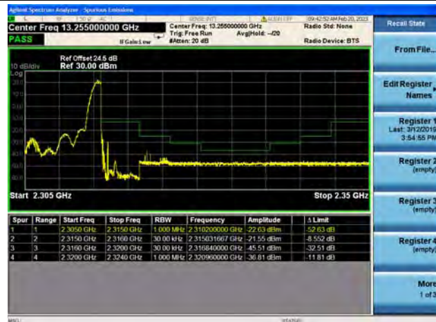
Band40 / 5MHz / High CH / QPSK / 1 RB
