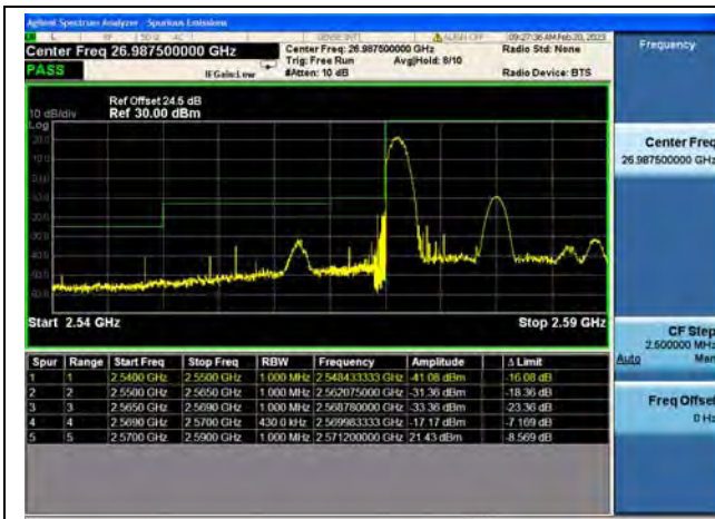
Band38 / 20MHz / Low CH / QPSK / 1 RB
