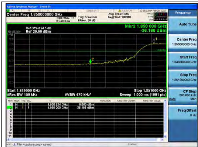
Band2 / 15MHz / Low CH / QPSK / 1 RB
