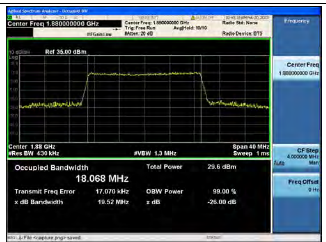
Band2 / 20MHz / 16QAM/ Mid CH
