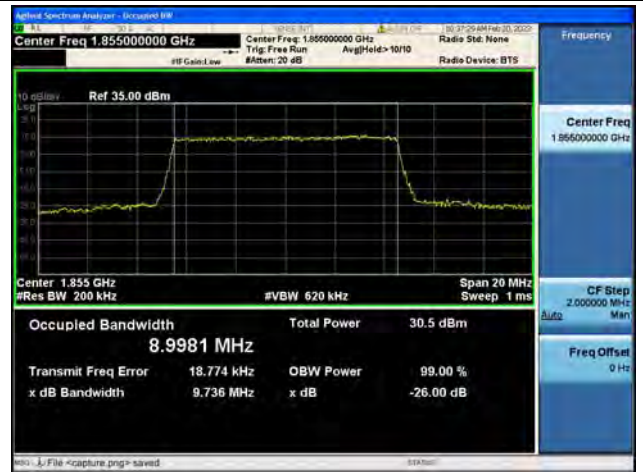
Band2 / 10MHz / QPSK / Low CH
