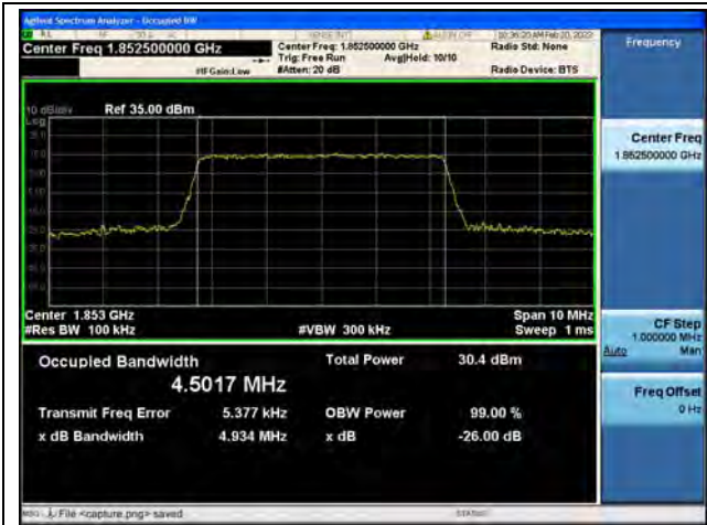
Band2 / 5MHz / QPSK/ Low CH
