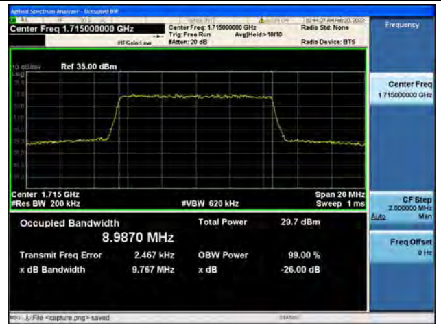
Band4 / 10MHz / 64QAM / Low CH
