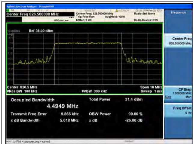
Band5 / 5MHz / QPSK/ Low CH
