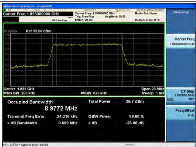
Band2 / 10MHz / 16QAM / Low CH
