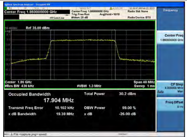
Band2 / 20MHz / QPSK/ Low CH
