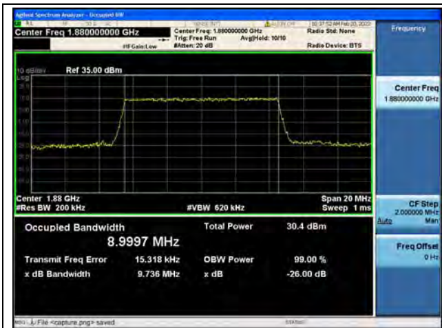
Band2 / 10MHz / QPSK/ Mid CH
