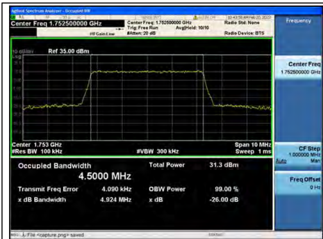
Band4 / 5MHz / QPSK / High CH
