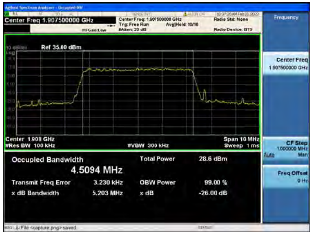
Band2 / 5MHz / 64QAM / High CH
