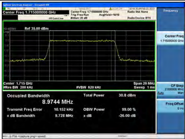
Band4 / 10MHz / 16QAM / Low CH
