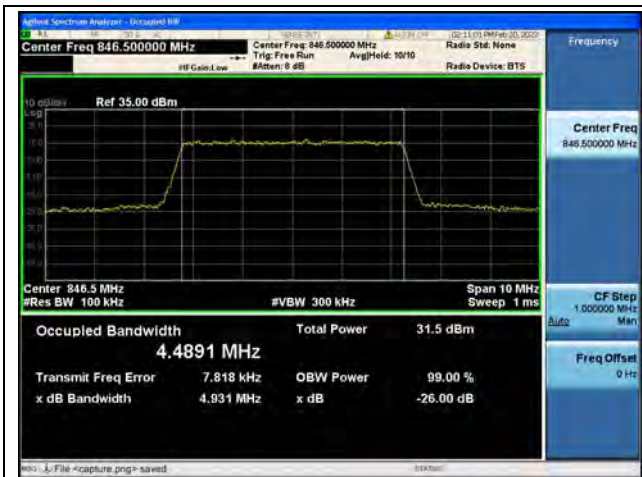
Band5 / 5MHz / QPSK / High CH
