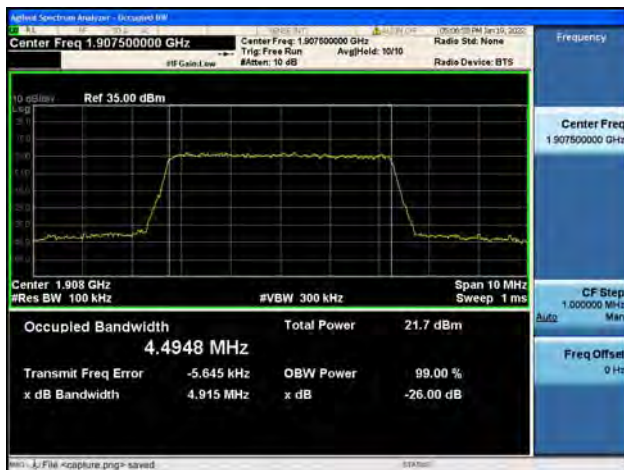
Band2 / 5MHz / High CH / QPSK
