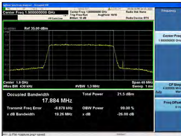
Band2 / 20MHz / High CH / QPSK
