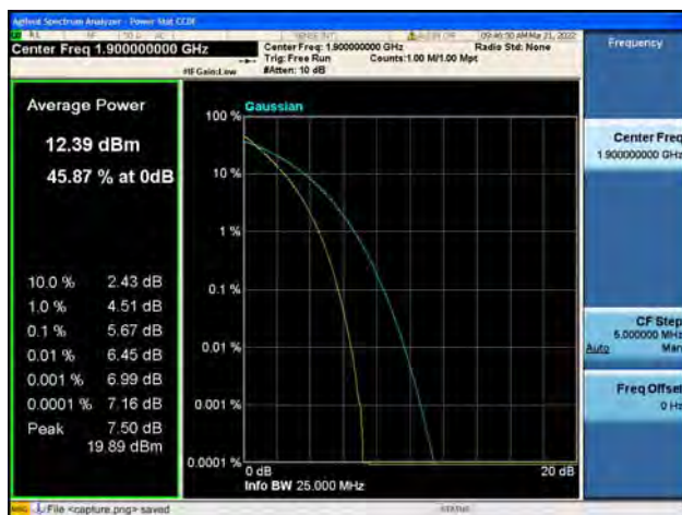
Band2 / 20MHz / High CH / QPSK
