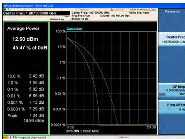
Band2 / 5MHz / High CH / QPSK
