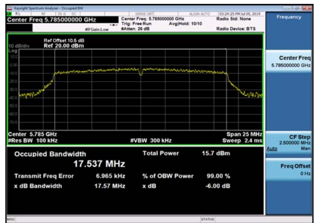
U-NII-3 6dB Bandwidth-802.11ac(40MHz) ,5755MHz,Ant1
