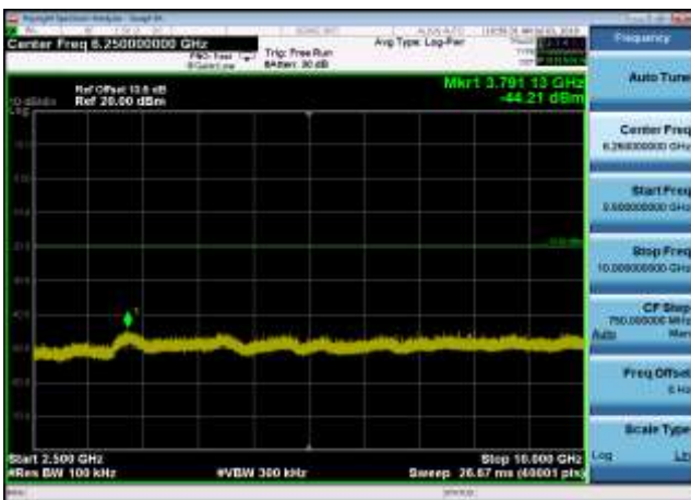
,Plot 4,2500MHz~10000MHz-802.11n(HT20) ,2437MHz
