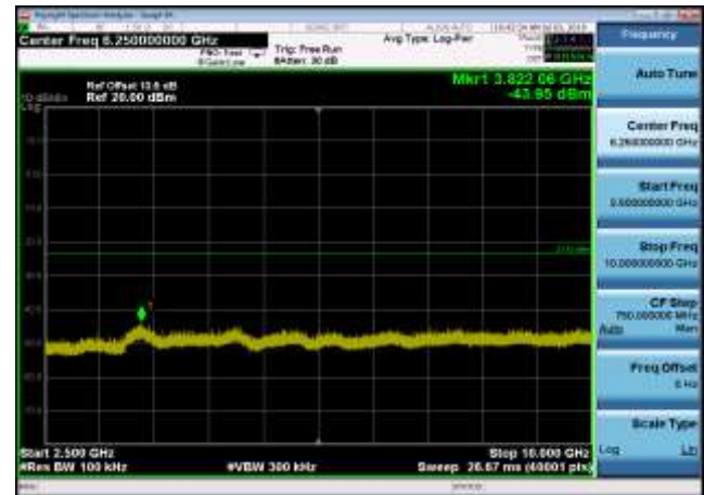
,Plot 4,2500MHz~10000MHz-802.11n(HT20) ,2462MHz
