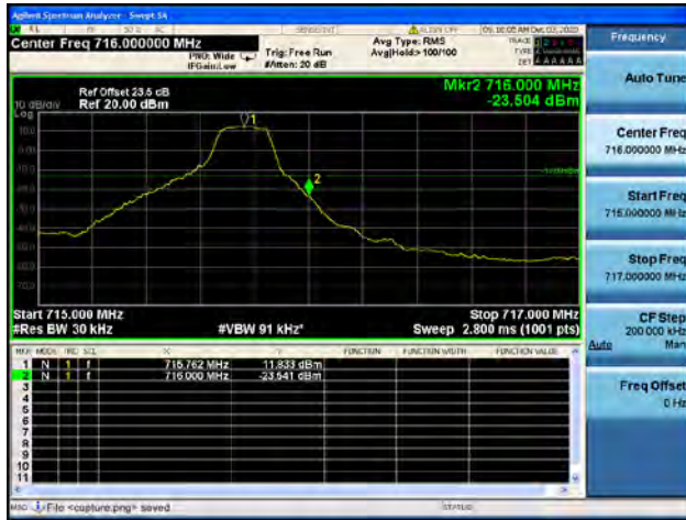
Band12 / 5MHz / Low CH / QPSK / 1 RB
