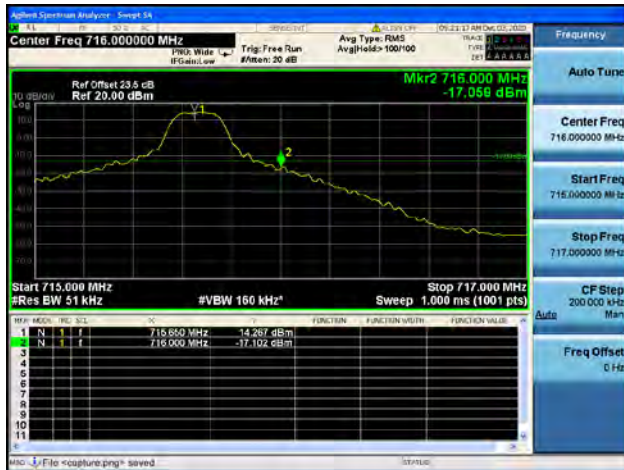
Band17 / 10MHz / Low CH / QPSK / 1 RB
