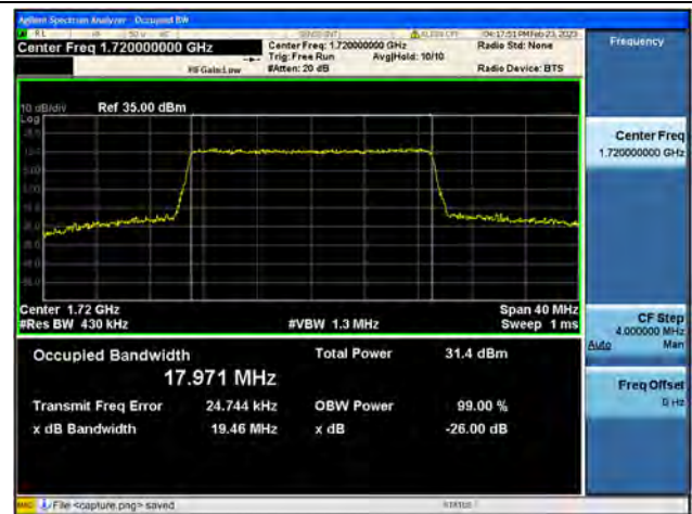
Band4 / 20MHz / QPSK/ Low CH
