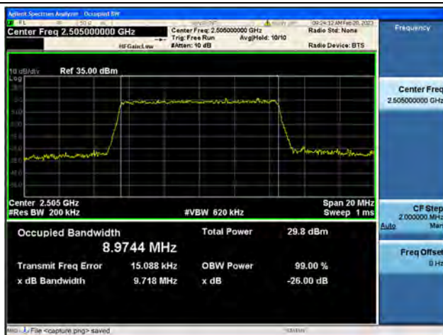
Band 7 / 10MHz / 16QAM / Low CH
