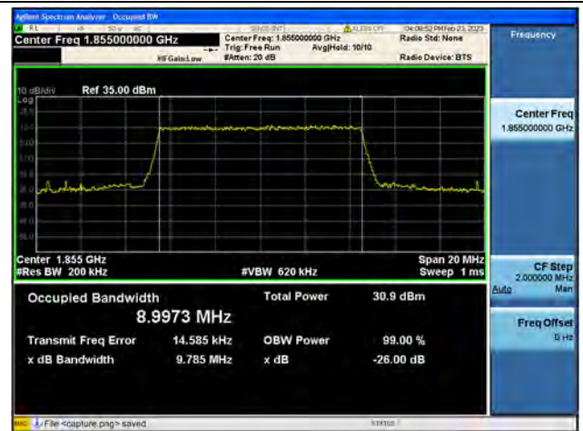
Band2 / 10MHz / QPSK/ Low CH
