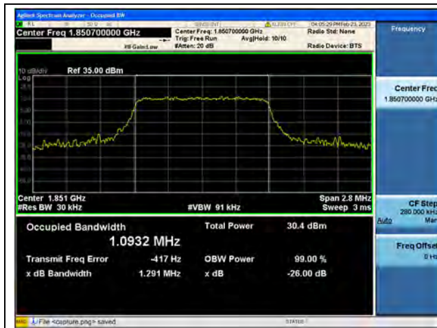
Band2 / 1.4MHz / QPSK/ Low CH
