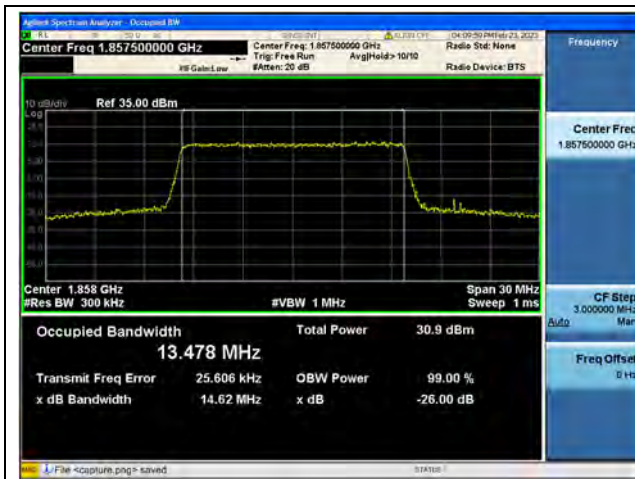
Band2 / 15MHz / QPSK/ Low CH
