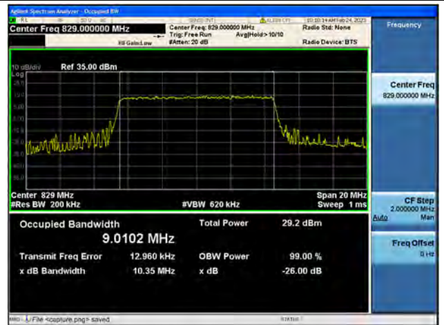
Band5 / 10MHz / QPSK/ Low CH
