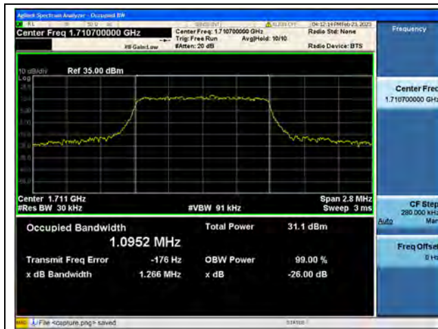
Band4 / 1.4MHz / QPSK/ Low CH
