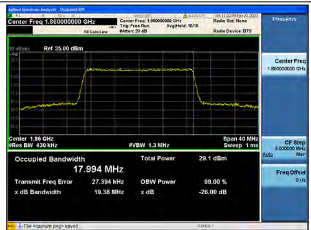
Band2 / 20MHz / 64QAM/ Low CH
