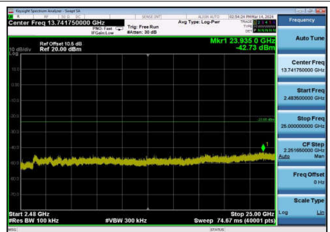
,Plot 4,2483.5MHz~25000MHz-802.11g ,2462MHz,Ant0
