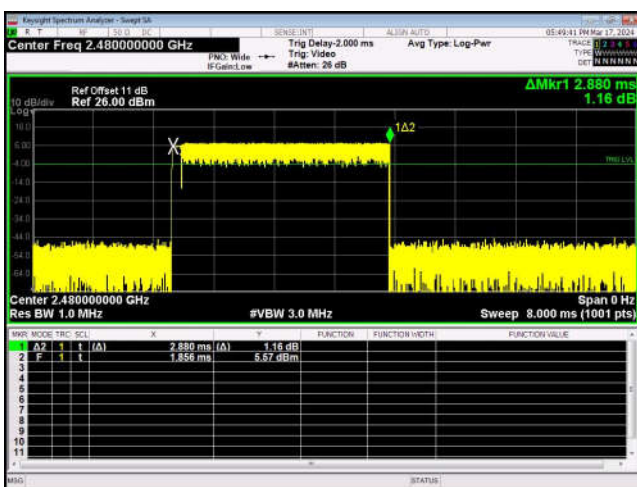
Pulse Width \pi/4 QPSK_2-DH5
