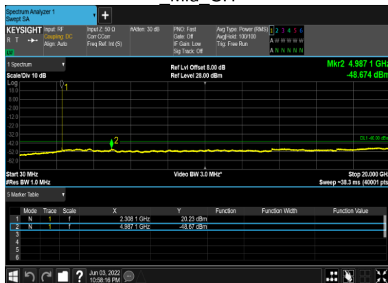
B5_N30(5M)_DFT-s-OFDM_BPSK_Edge_1RB_Left Mid CH
