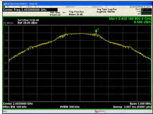
Tx. Spurious NVNT 1-DH5 2402MHz Ant1 Emission
