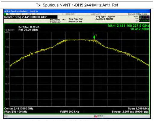
Tx. Spurious NVNT 1-DH5 2441MHz Ant1 Emission
