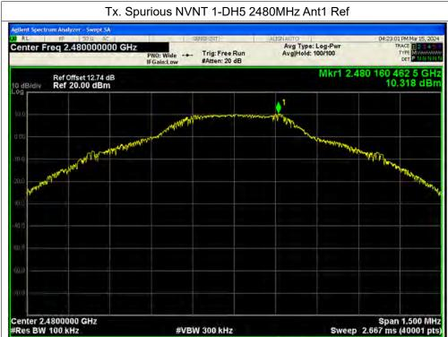
Tx. Spurious NVNT 1-DH5 2480MHz Ant1 Emission
