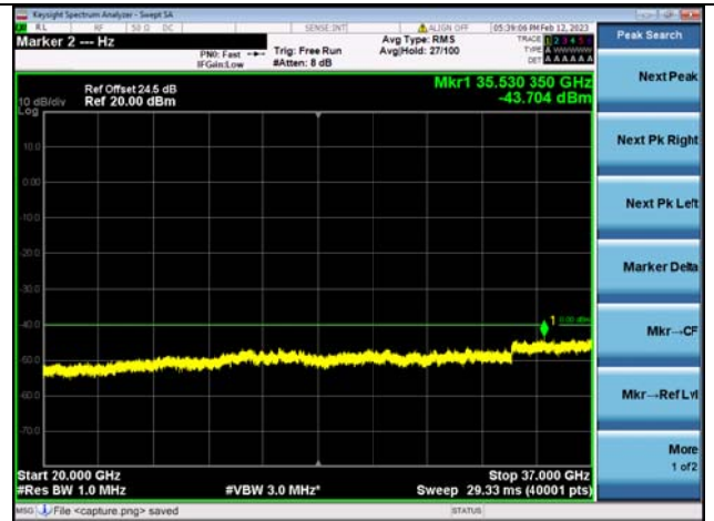
Band48C-20G-37G / 20MHz+5MHz / 1RB+1RB / QPSK / Low CH
