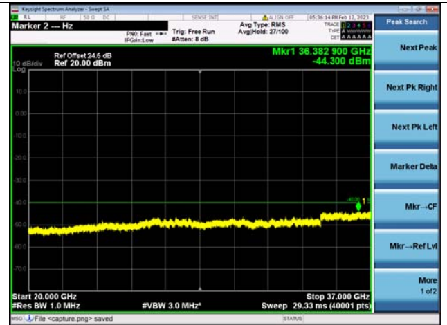
Band48C-20G-37G / 5MHz+20MHz / 1RB+1RB / QPSK / Low CH
