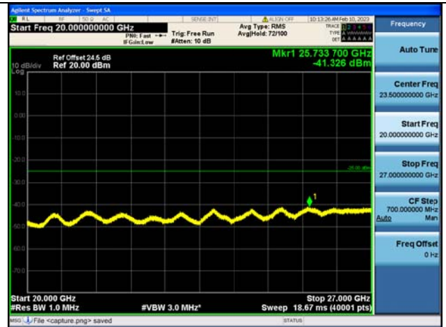
Band41C-20G-27G / 10MHz+20MHz / 1RB+1RB/ QPSK / Mid CH
