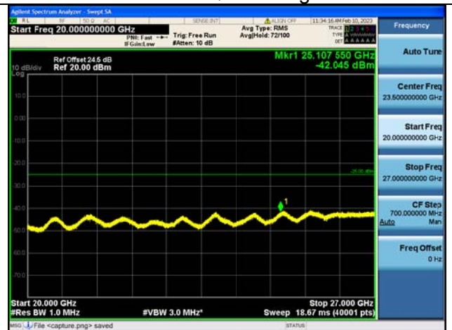
Band41C-20G-27G / 15MHz+10MHz /75RB+50RB/ QPSK / High CH
