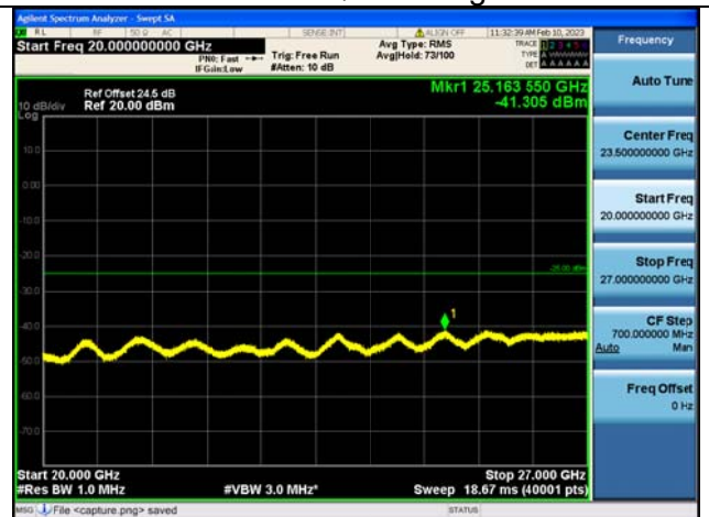
Band41C-20G-27G / 10MHz+15MHz /50RB+75RB/ QPSK / High CH
