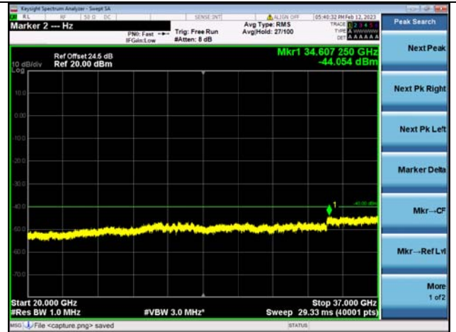
Band48C-20G-37G / 20MHz+5MHz / 100RB+25RB / QPSK / Low CH
