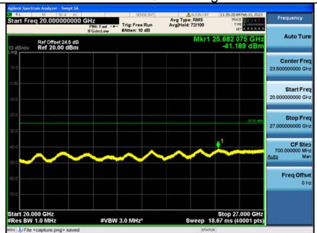
Band41C-20G-27G / 10MHz+20MHz / 1RB+1RB/ QPSK / High CH
