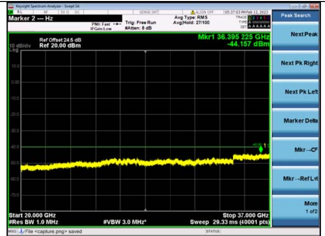
Band48C-20G-37G / 5MHz+20MHz / 25RB+100RB / QPSK / Low CH
