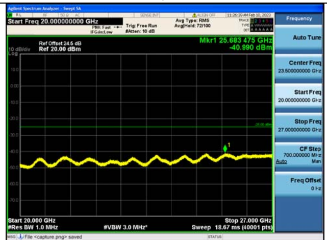
Band41C-20G-27G / 20MHz+20MHz /100RB+100RB/ QPSK / Mid CH
