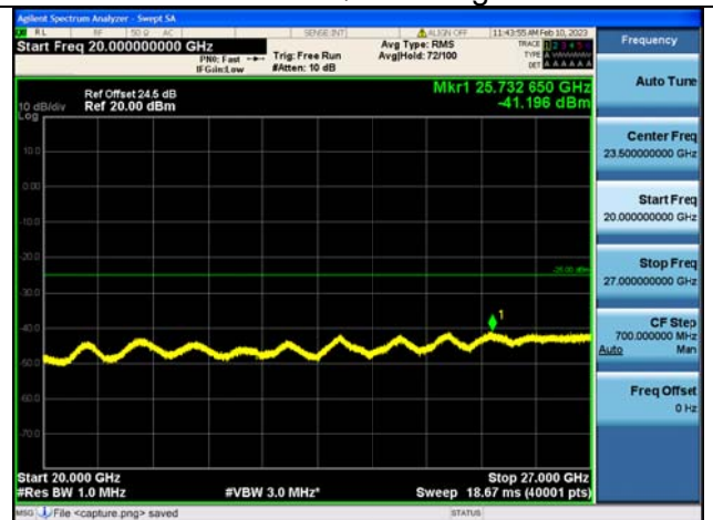
Band41C-20G-27G / 20MHz+20MHz /100RB+100RB/ QPSK / High CH
