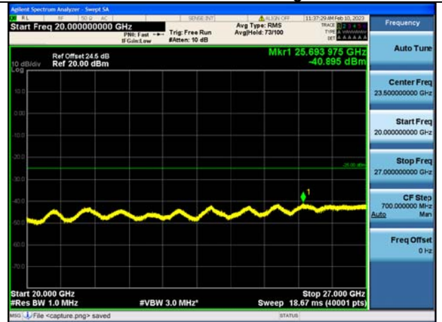
Band41C-20G-27G / 20MHz+10MHz /100RB+50RB/ QPSK / High CH
