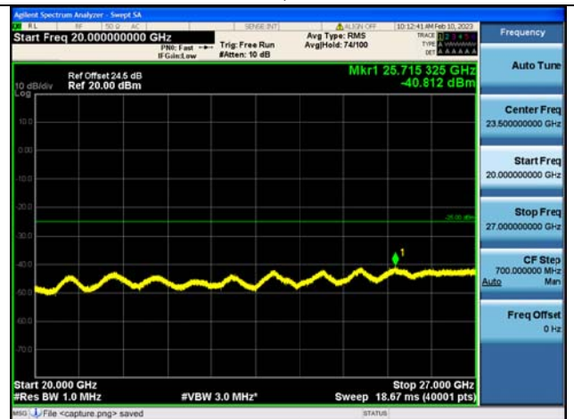
Band41C-20G-27G / 15MHz+10MHz /75RB+50RB/ QPSK / Mid CH
