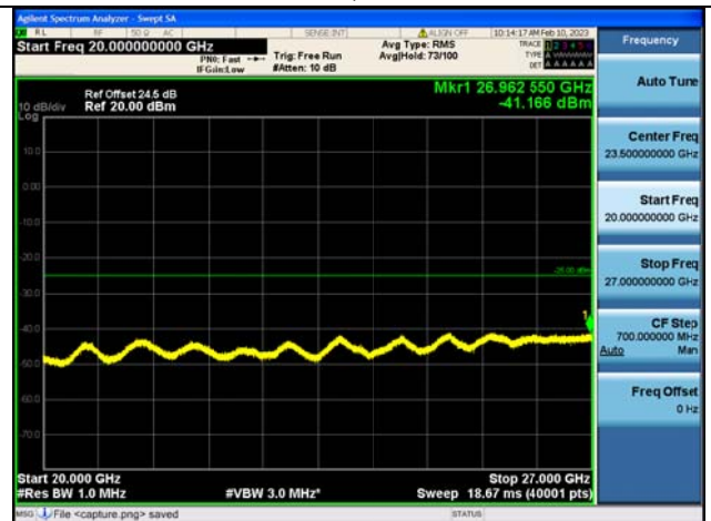
Band41C-20G-27G / 10MHz+20MHz / 50RB+100RB/ QPSK / Mid CH
