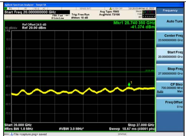
Band41C-20G-27G / 15MHz+20MHz / 75RB+100RB/ QPSK / Mid CH
