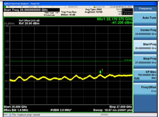
Band41C-20G-27G / 20MHz+20MHz /1RB+1RB/ QPSK / Mid CH
