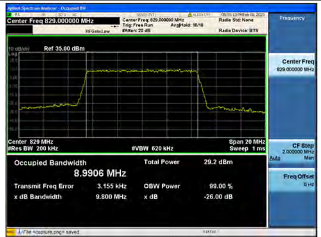
Band5 / 10MHz / QPSK/ Low CH
