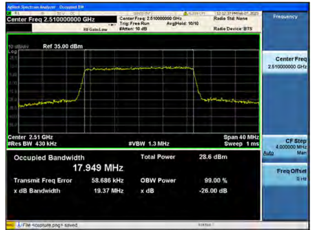
Band7 / 20MHz / QPSK/ Low CH
