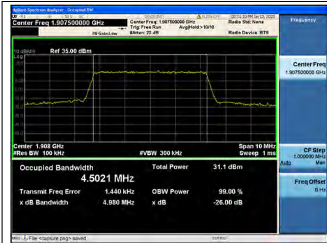
Band2 / 5MHz / QPSK/ High CH
