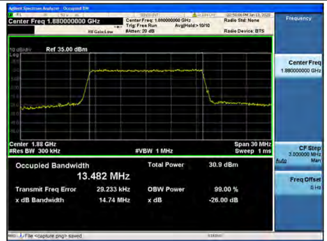
Band2 / 15MHz / QPSK/ Mid CH
