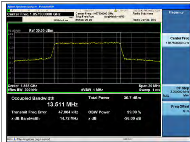
Band2 / 15MHz / QPSK/ Low CH
