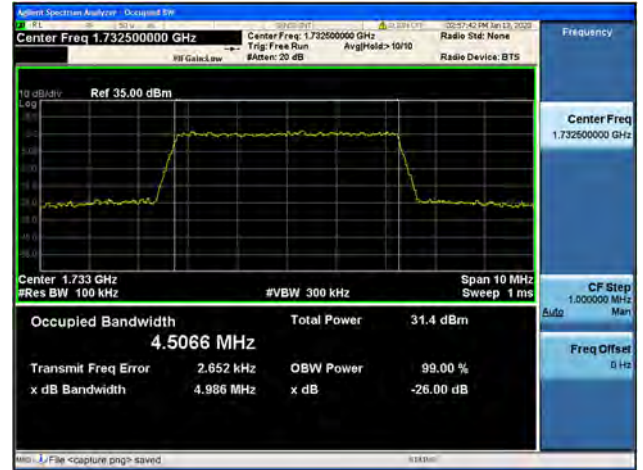
Band4 / 5MHz / QPSK/ Mid CH
