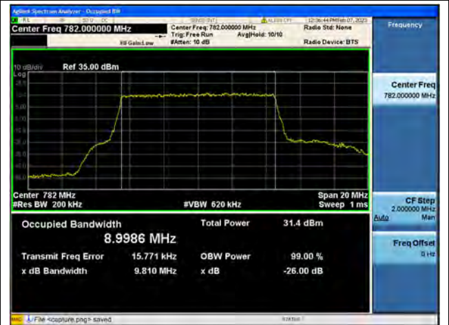
Band13 / 10MHz / QPSK/ Low CH
