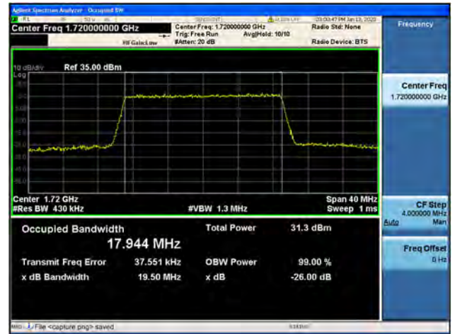
Band4 / 20MHz / QPSK/ Low CH
