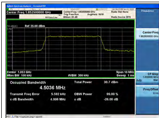
Band2 / 5MHz / QPSK/ Low CH
