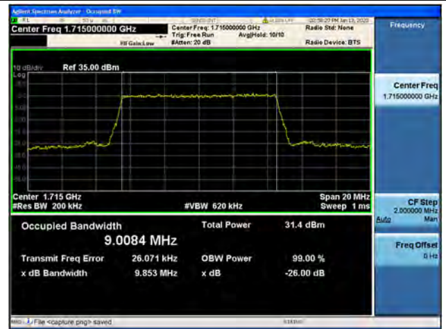
Band4 / 10MHz / QPSK/ Low CH
