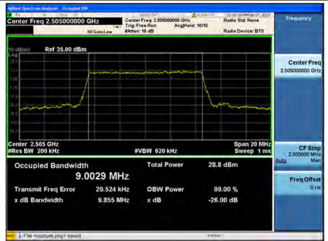
Band7 / 10MHz / QPSK / Low CH
