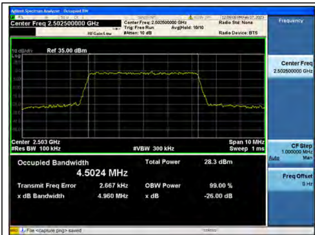
Band7 / 5MHz / QPSK/ Low CH
