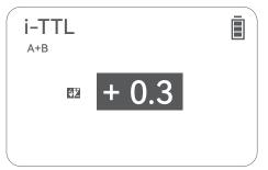
旋转调节拔轮即可设置曝光补偿值,可以在 ±3 档间以 1/3 档为增量设置。
