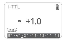
2. 短按SET按键可选<置>曝光补偿值/A:B闪光光比值,选中后旋转调节拔轮即可设置曝光补偿值/A:B闪光光比。设置曝光补偿值,可以在±3档间以1/3档为增量设置。设置A:B闪光光比,可在8:1-1:8闪光光比间以1/2档为增量设置。
