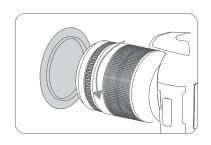
小提示: 本产品配有 8 种规格的适配环,与相机镜头 颈圈相符: 49mm、52mm、55mm、58mm、62mm、67mm、72mm 和 77mm。
