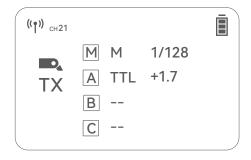
注: TTL表示TTL自动闪光, M表示M手动闪光、--表示关闭。
