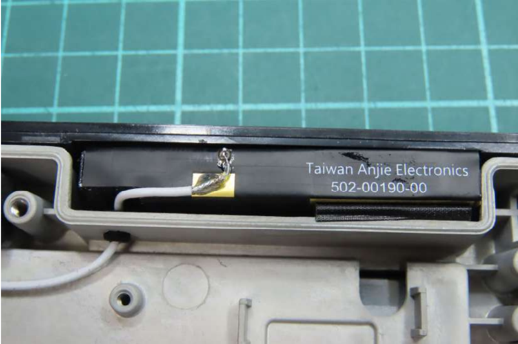
(47) EUT Photo_WWAN AUX Antenna
