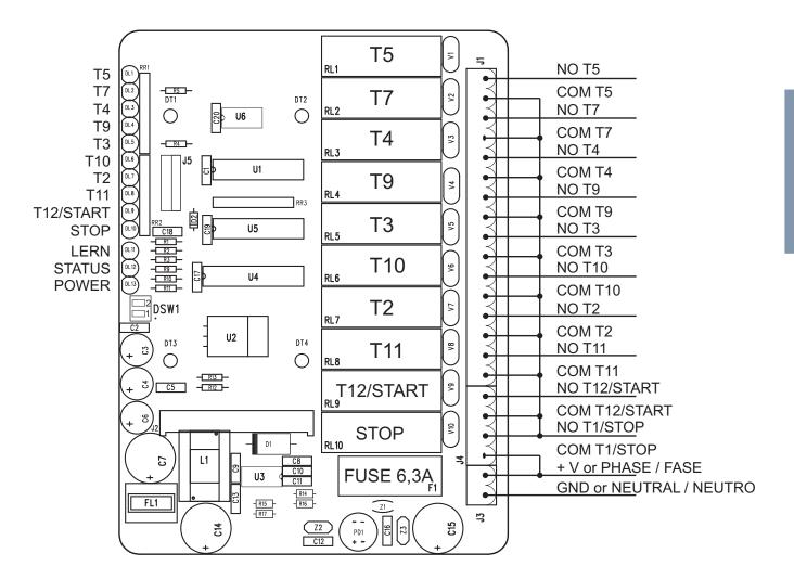
Relay T12/START is activated pressing T8 (Alarm) on the transmitter. *II relè T12/START si attiva alla pressione di T8 (Allarme) sul trasmettitore.*
