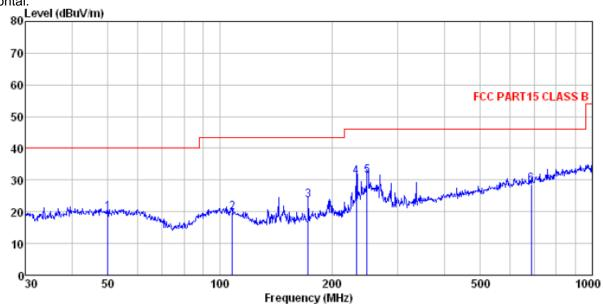
: 3m chamber : FCC PART15 CLASS B 3m VULB9163-2013M HORIZONTAL : 993RF
