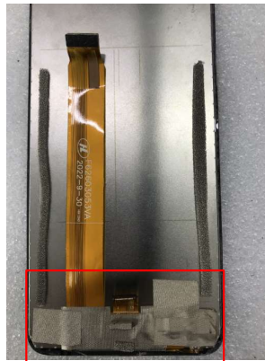
屏幕排线贴导电布做接地处理，导电布面积需要超过屏幕排线贴在屏幕的铁框处。导电布也需要采用内阻低的
