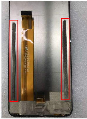
屏幕增加导电泡棉与中框金属相接，此处泡棉需要使用低内阻的，原有泡棉内阻太高，需要更换
