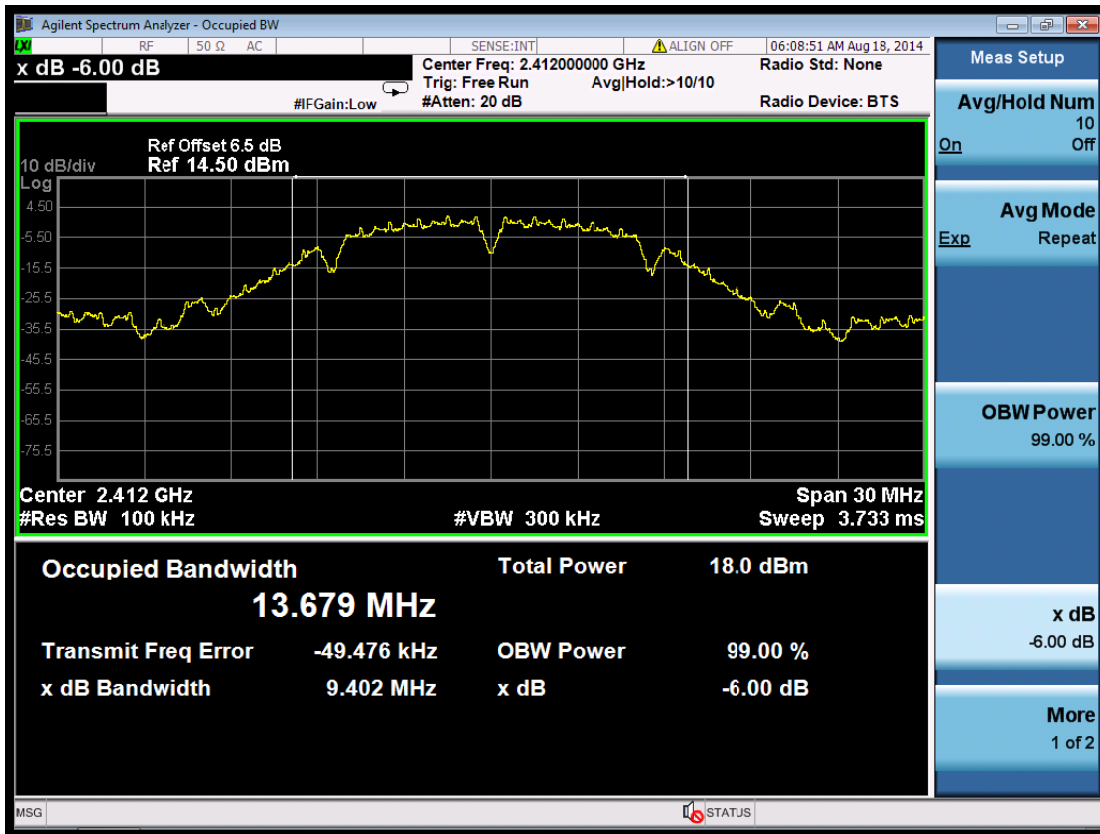
(Plot 6.7.1 A: Channel 1: 2412MHz @ 802.11b)
