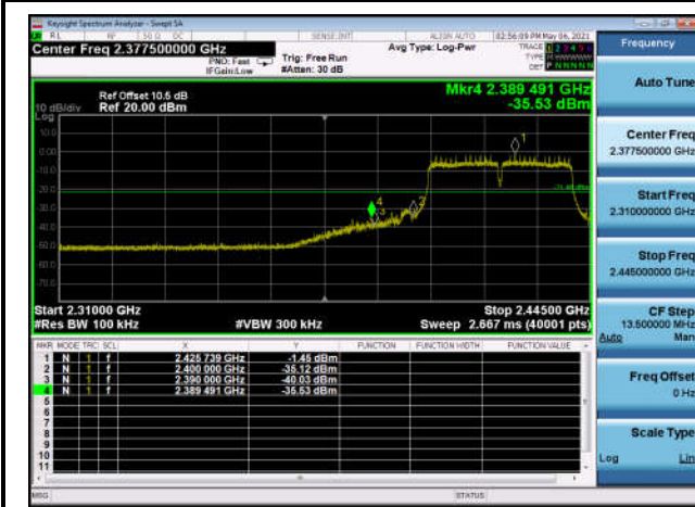
,Plot 2,Band Edge-802.11n(HT40) ,2452MHz,Ant0
