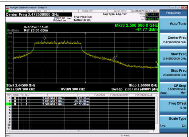
,Plot 2,Band Edge-802.11n(HT20) ,2462MHz,Ant0
