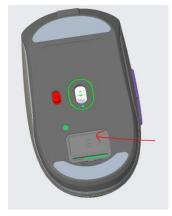
2: 打开电源开关至 ON 位置(上下为 ON,中间是 OFF),在电脑桌面空白处,任意点击鼠标 左键或右键。当移动鼠标时,光标可以移动。此时你可以轻松使用你的 2.4G 无线光学鼠标
