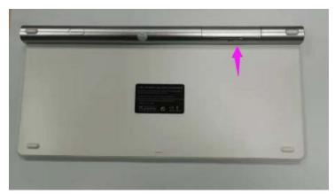
2: 将 2 节 3A 电池放入键盘的收藏盒(注意正负极),盖上收藏盒的盖子。点击键盘任何一个字母,键盘与 MINI 接收器都可以连接。连接之后,你就可以使用的你无线键盘了。如果发现连接不上时,你可以拔出 MINI 接收器,按住键盘 ESC+Q 不松手,指示灯红色闪烁,然后再将 MINI 接收器插入电脑 USB 口,当指示灯不闪时,松开 ESC+Q 键,说明键盘与 MINI 接收器已经连接上了,这样你可以使用你的无线键盘了。
