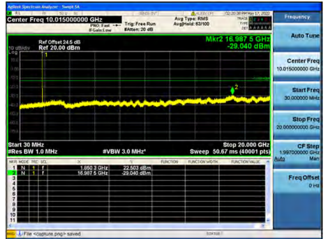
Band2 / 5MHz / Mid CH / QPSK
