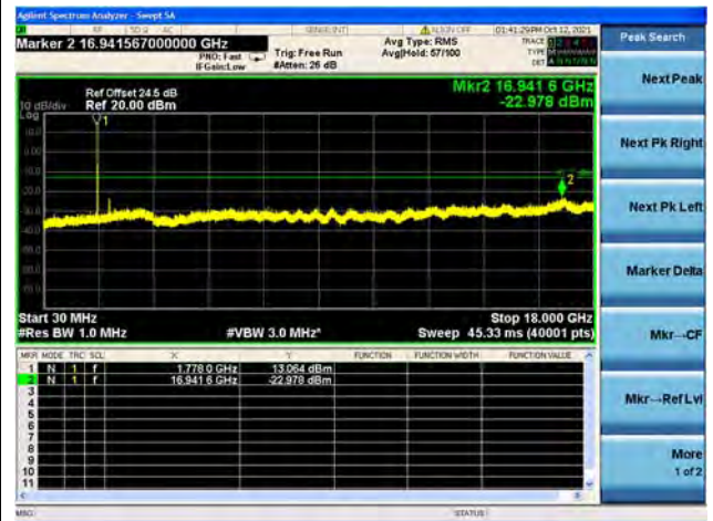
Band66 / 10MHz / Low CH / QPSK
