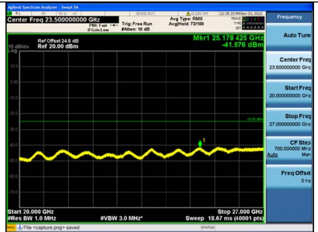
Band41C-20G-27G / 15MHz+10MHz / 1RB+1RB/ QPSK / LOW CH
