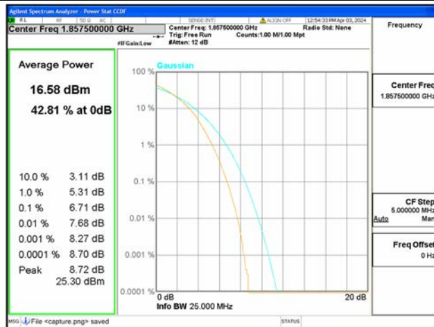
B2 / 15MHz / Low CH / 64QAM
