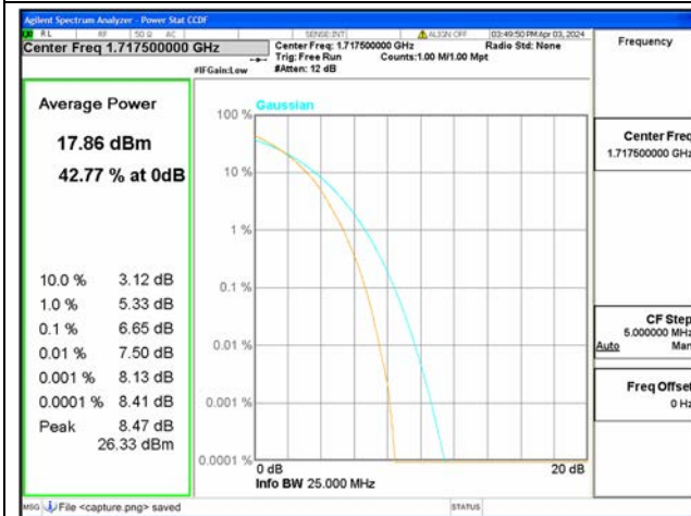
B66 / 15MHz / Low CH / 64QAM
