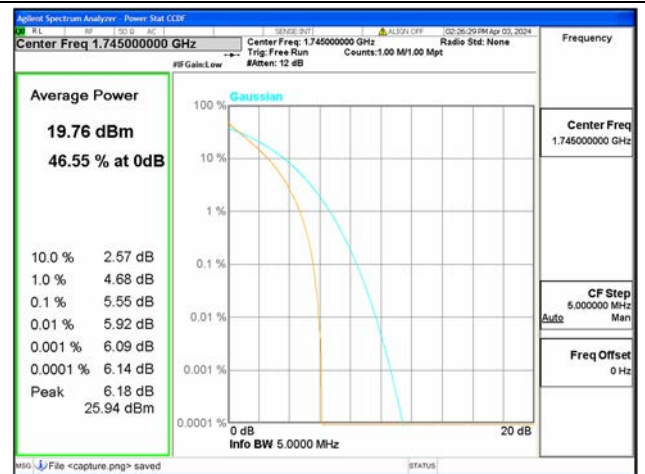
B66 / 1.4MHz / Mid CH / QPSK
