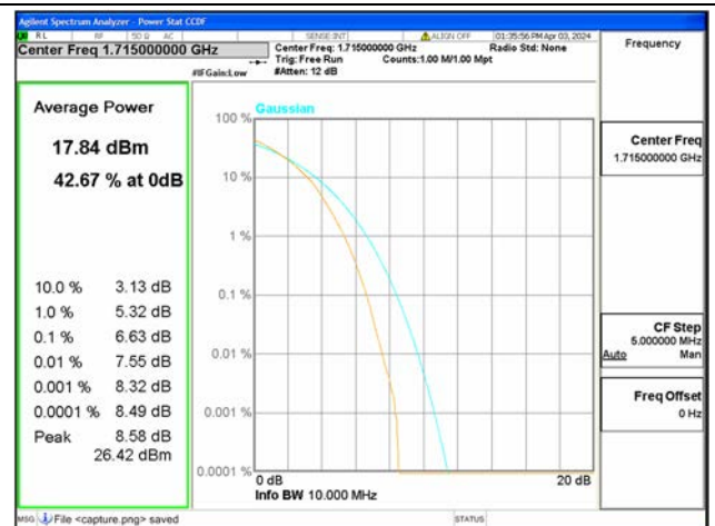
B4 / 10MHz / Low CH / 64QAM
