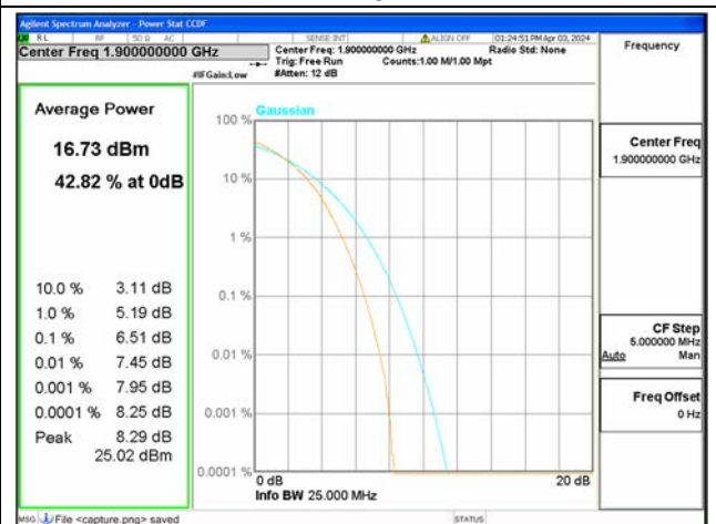
B2 / 20MHz / High CH / 64QAM
