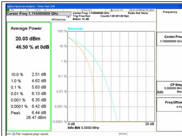
B66 / 3MHz / Mid CH / QPSK
