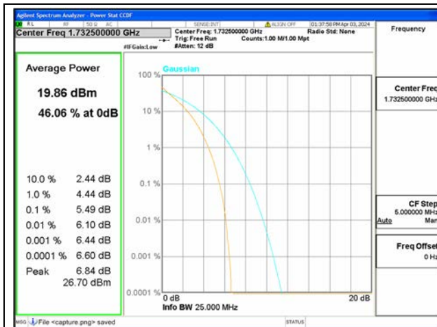
B4 / 20MHz / Mid CH / QPSK
