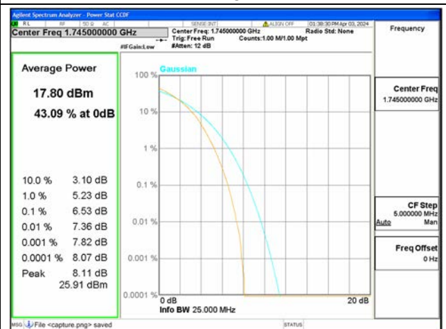
B4 / 20MHz / High CH / 64QAM
