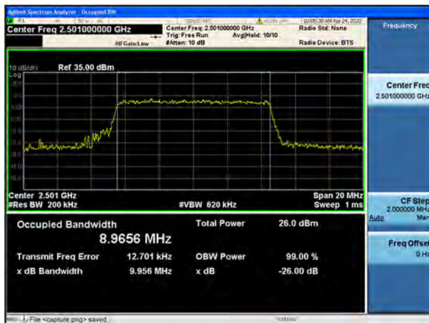
Band41 / 10MHz / Low CH / 16QAM
