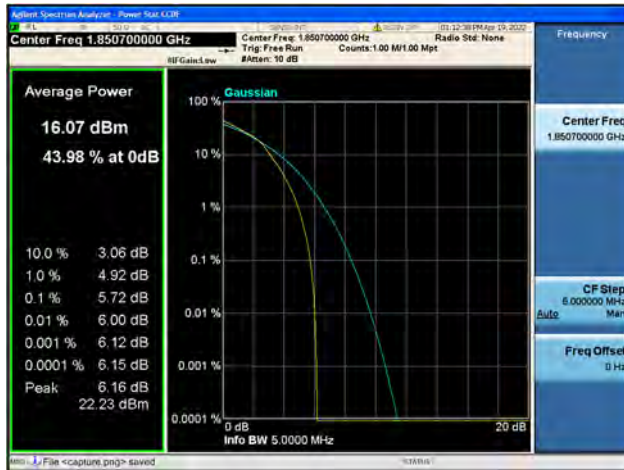
Band2 / 1.4MHz / Mid CH / 16QAM
