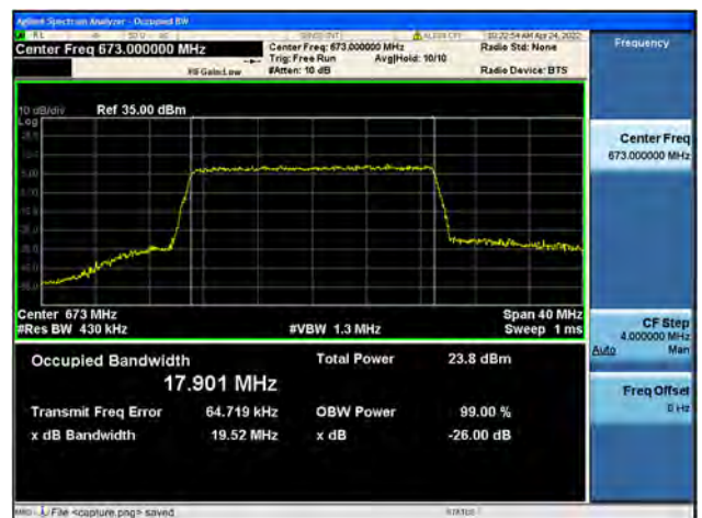
Band71 / 20MHz / Low CH / 64QAM
