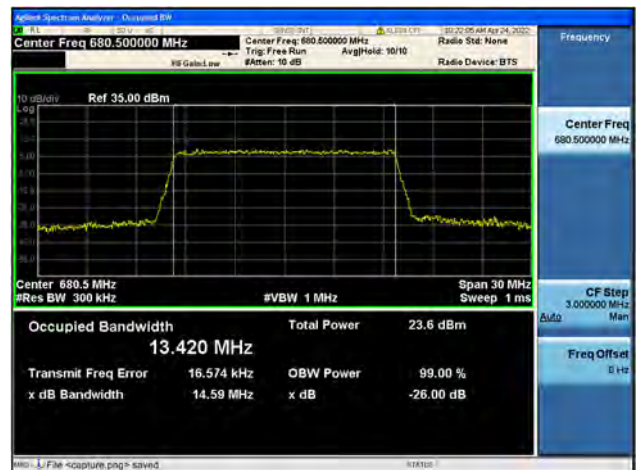
Band71 / 15MHz / Mid CH / 64QAM
