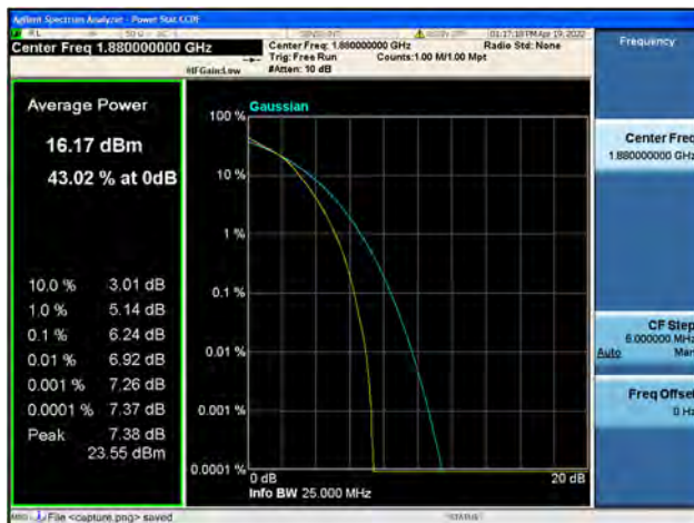
Band2 / 15MHz / Mid CH / 16QAM
