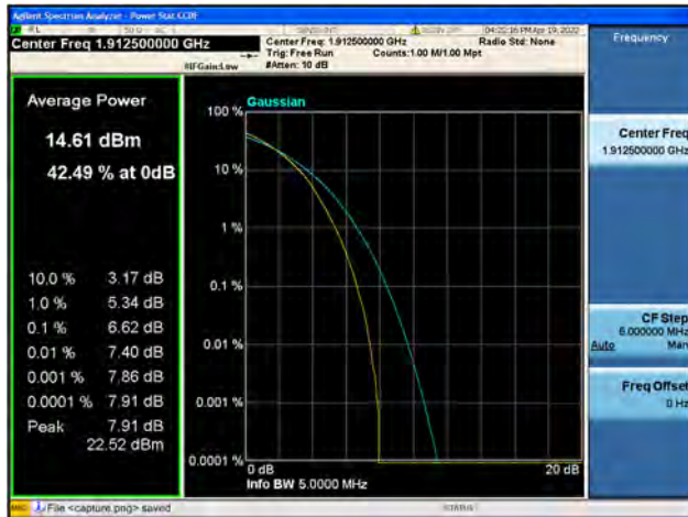
Band25 / 10MHz / Low CH / 16QAM
