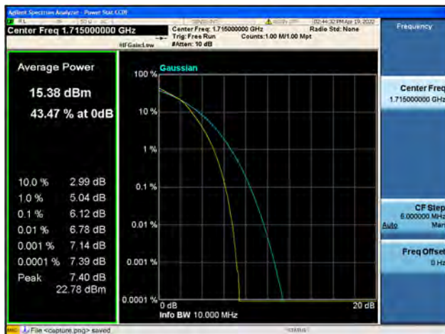
Band66 / 10MHz / Low CH / 16QAM
