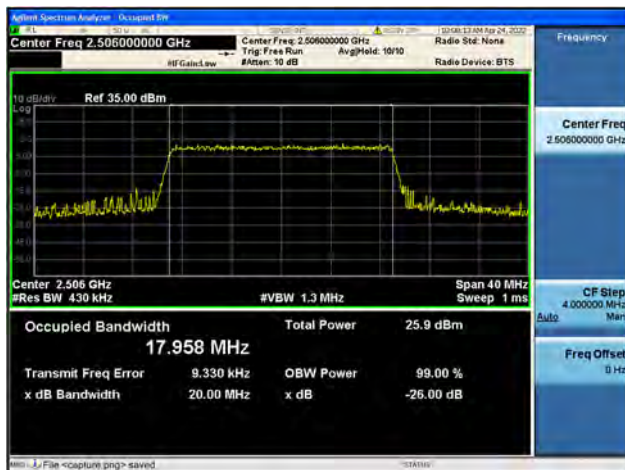
Band41 / 20MHz / Low CH / 16QAM
