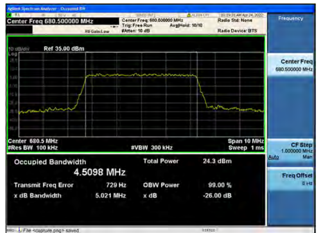
Band71 / 5MHz / Mid CH / 64QAM
