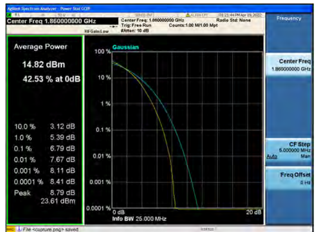
Band2 / 20MHz / Low CH / 64QAM
