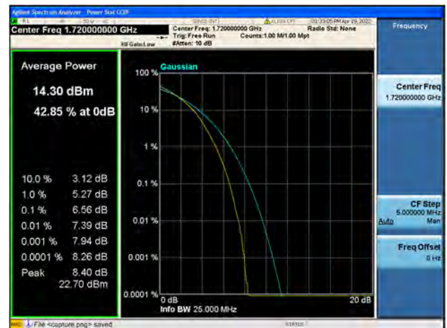
Band4 / 20MHz / Low CH / 64QAM
