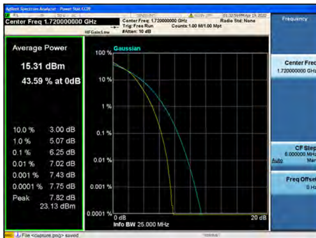
Band4 / 20MHz / Low CH / 16QAM
