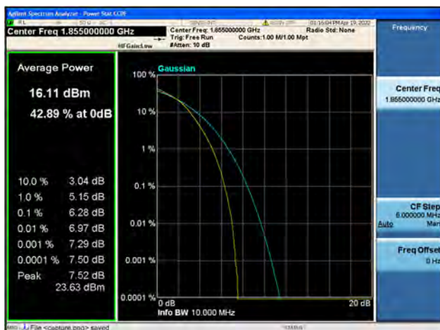
Band2 / 10MHz / Low CH / 16QAM
