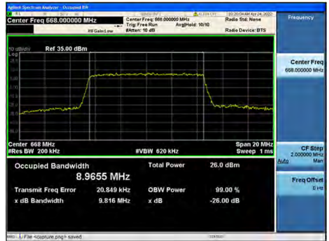
Band71 / 10MHz / Low CH / 64QAM
