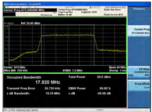
Band71 / 20MHz / Low CH / 64QAM
