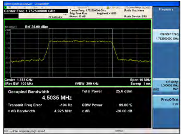
Band4 / 10MHz / Low CH / QPSK
