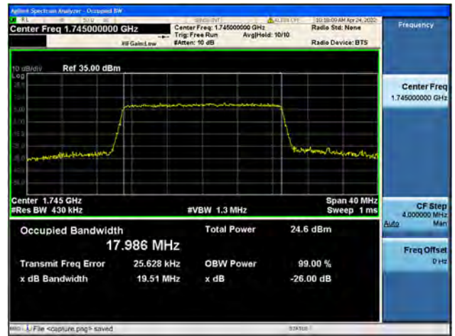
Band66 / 20MHz / High CH / QPSK
