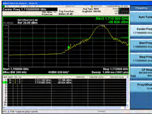
Band4 / 20MHz / High CH / QPSK / 1 RB
