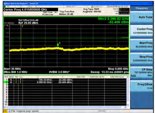
Band13 / 5MHz / Mid CH / 64QAM
