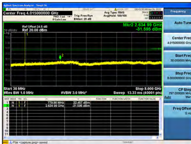
Band13 / 5MHz / Mid CH / 16QAM
