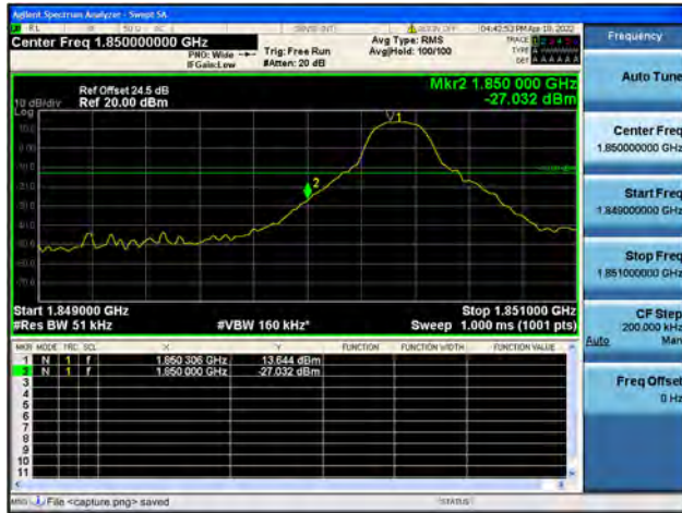
Band2 / 5MHz / High CH / QPSK / 1 RB
