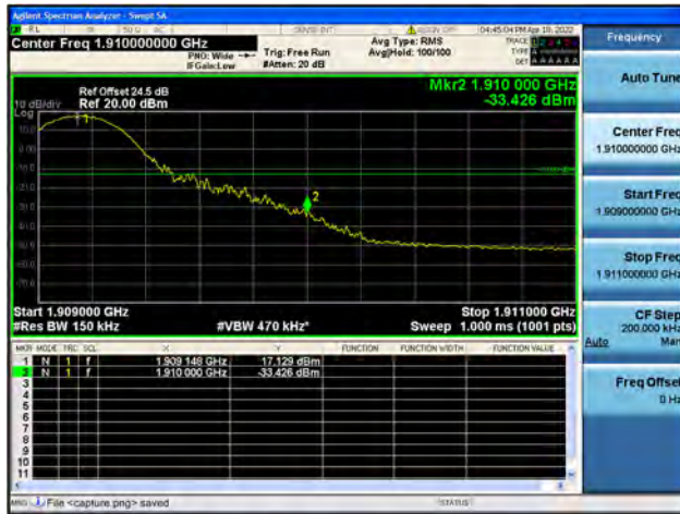
Band2 / 15MHz / High CH / QPSK / 1 RB
