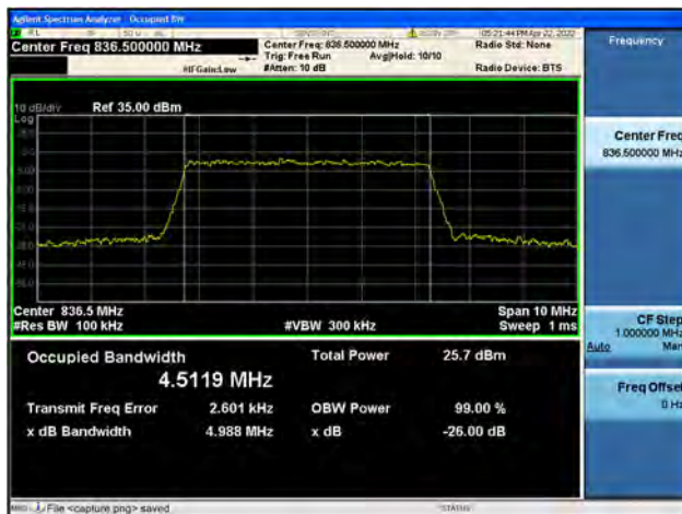
Band5 / 5MHz / Mid CH / 16QAM
