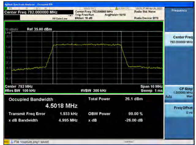
Band13 / 5MHz / Mid CH / 64QAM
