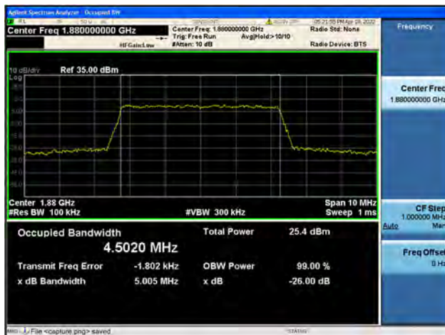
Band2 / 5MHz / Mid CH / 16QAM
