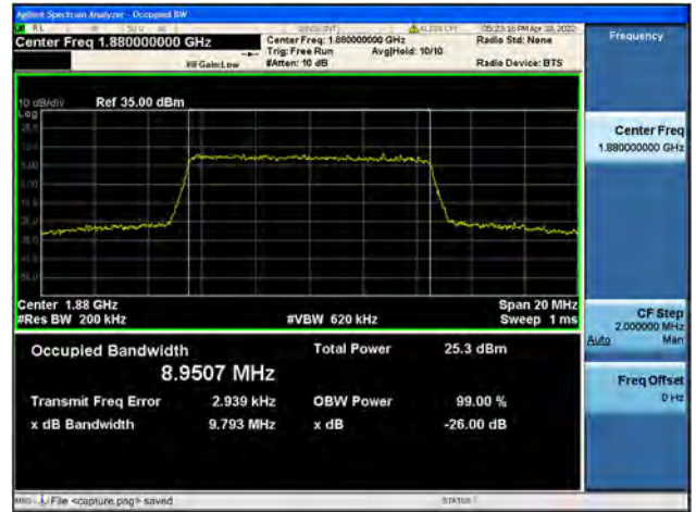
Band2 / 10MHz / High CH / QPSK
