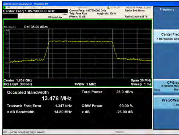
Band2 / 15MHz / Low CH / 64QAM
