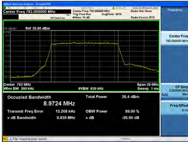
Band13 / 10MHz / Mid CH / 64QAM
