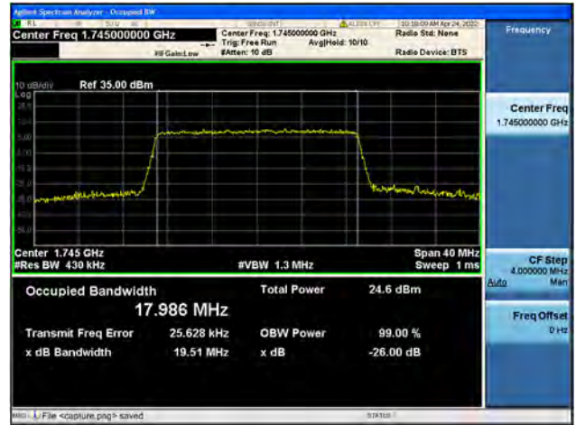
Band66 / 20MHz / High CH / QPSK
