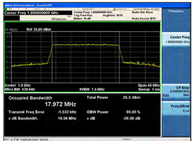
Band2 / 20MHz / High CH / 64QAM
