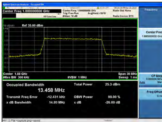
Band2 / 15MHz / Mid CH / 16QAM
