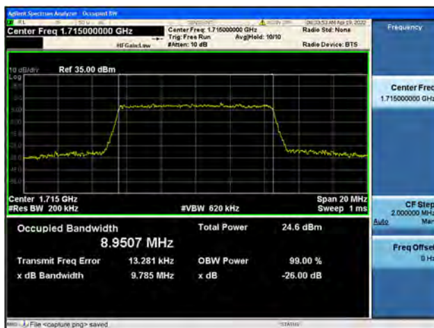
Band4 / 10MHz / Low CH / 16QAM
