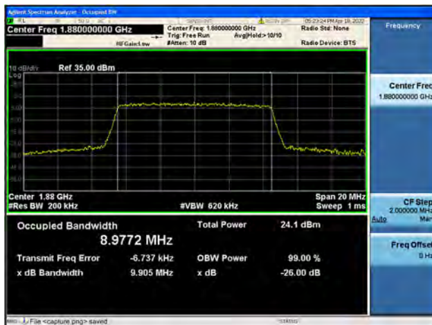
Band2 / 10MHz / High CH / 16QAM
