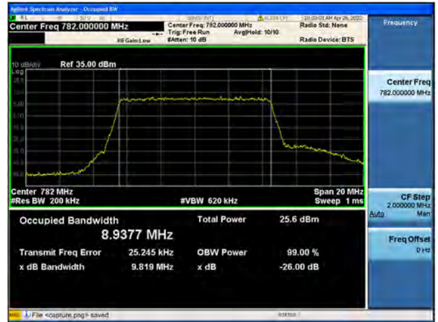
Band13 / 10MHz / High CH / QPSK
