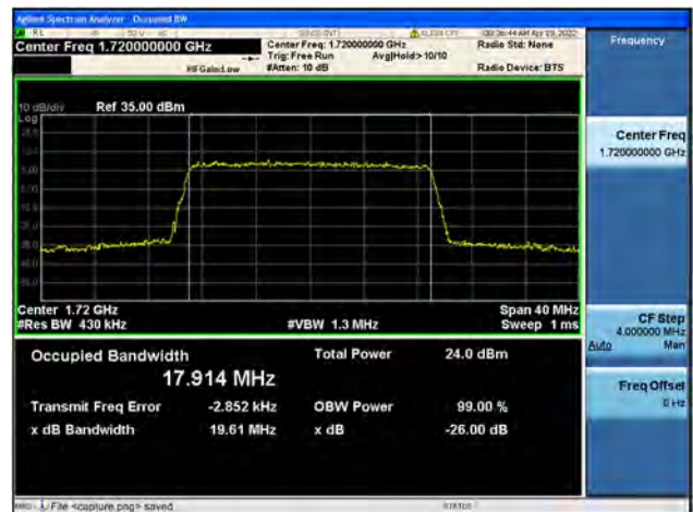
Band4 / 20MHz / Low CH / 64QAM
