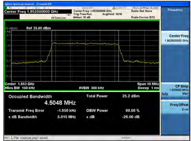
Band2 / 5MHz / Mid CH / QPSK
