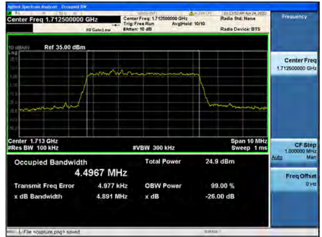
Band66 / 5MHz / Mid CH / QPSK
