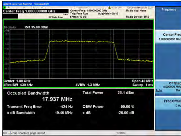
Band2 / 20MHz / Mid CH / 64QAM
