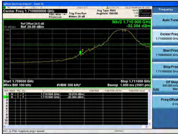
B66 / 10MHz / High CH / QPSK / 1 RB
