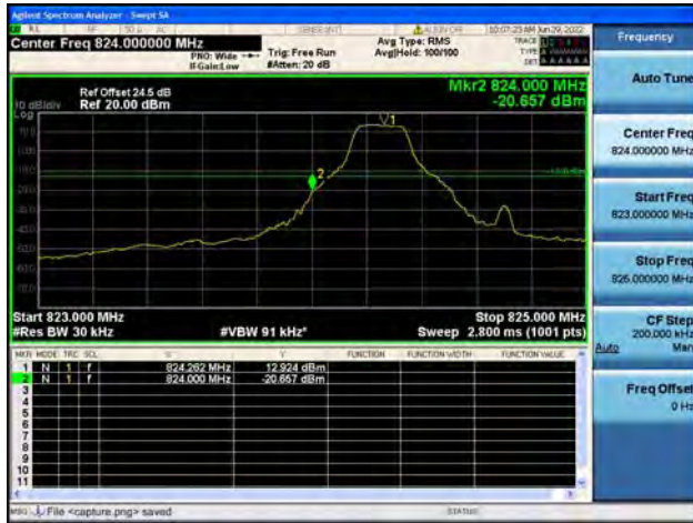
B5 / 1.4MHz / High CH / QPSK / 1 RB
