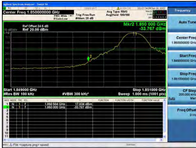
B2 / 10MHz / High CH / QPSK / 1 RB
