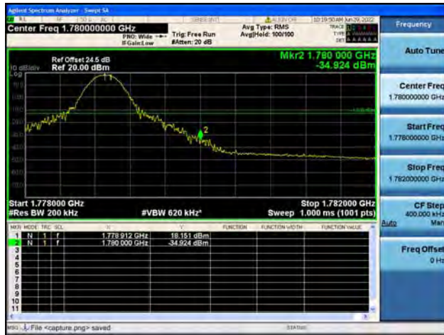
B66 / 20MHz / High CH / QPSK / 1 RB
