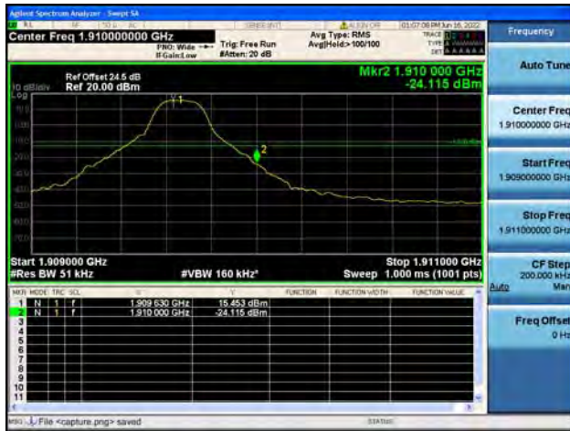
B2 / 5MHz / High CH / QPSK / 1 RB
