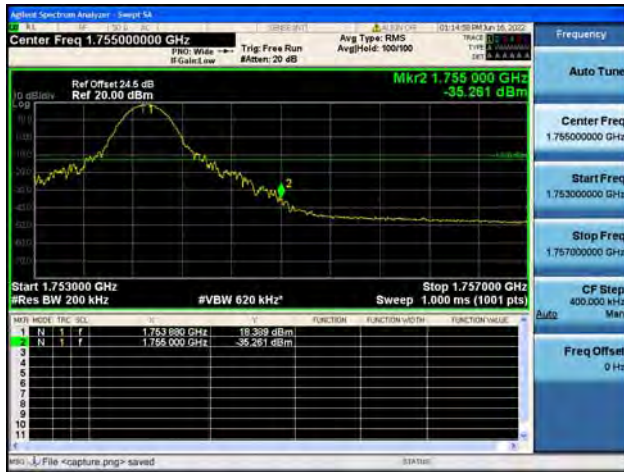
B4 / 20MHz / High CH / QPSK / 1 RB
