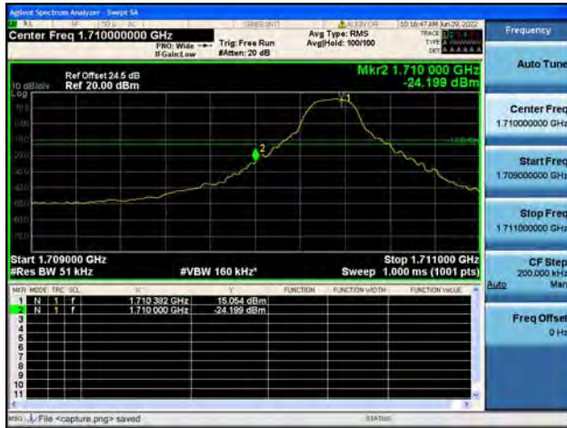
B66 / 5MHz / High CH / QPSK / 1 RB
