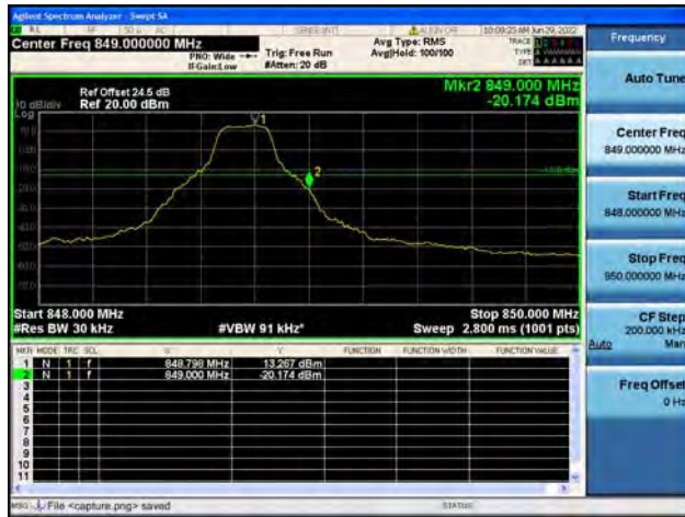
B5 / 3MHz / High CH / QPSK / 1 RB
