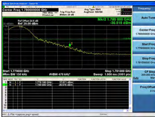
B66 / 15MHz / High CH / QPSK / 1 RB
