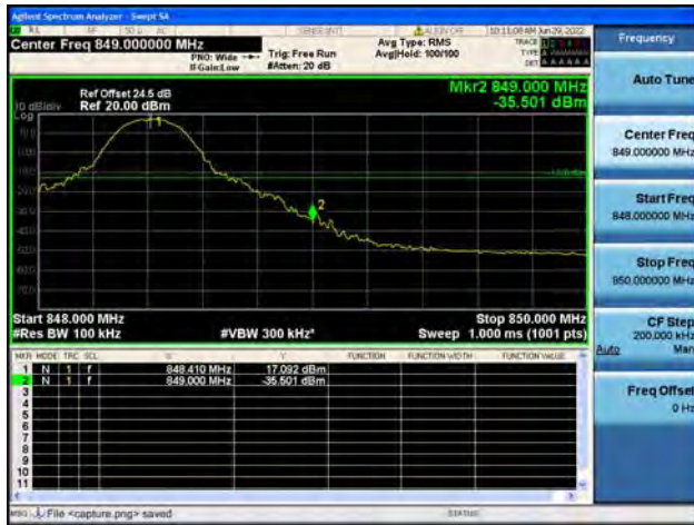
B5 / 10MHz / High CH / QPSK / 1 RB
