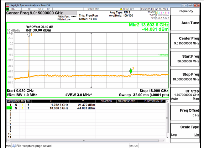
66C / 20+5MHz / QPSK / Mid CH / 1@99-1@0
