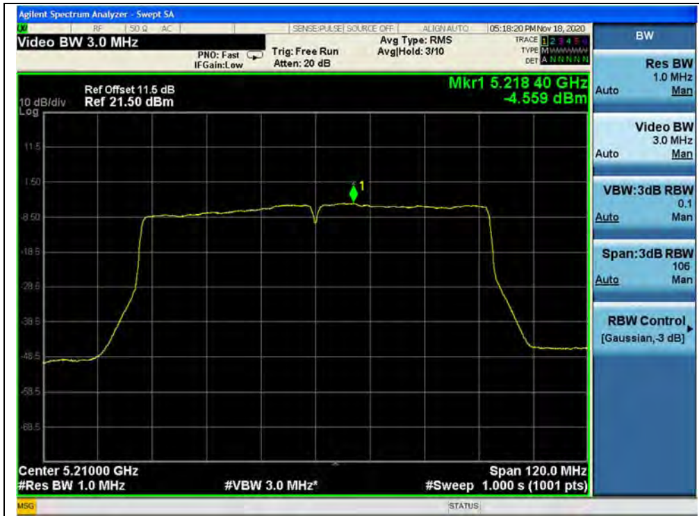
(Channel 42, 5210MHz, 802.11ac (VHT80), ANT1)
