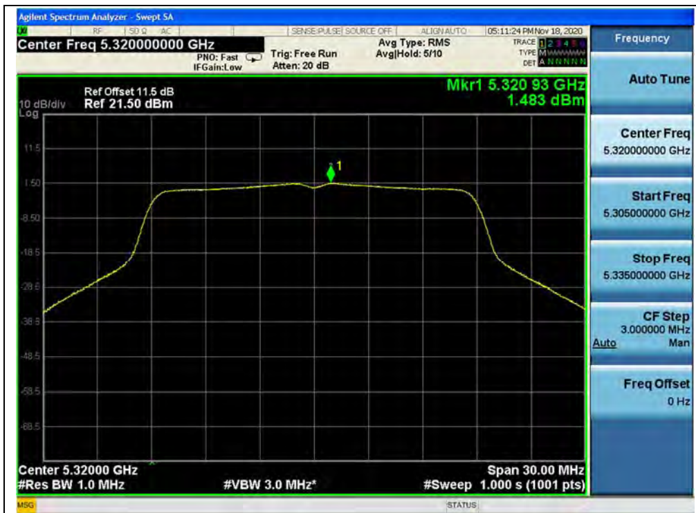
(Channel 64, 5320MHz, 802.11ac (VHT20), ANT1)
