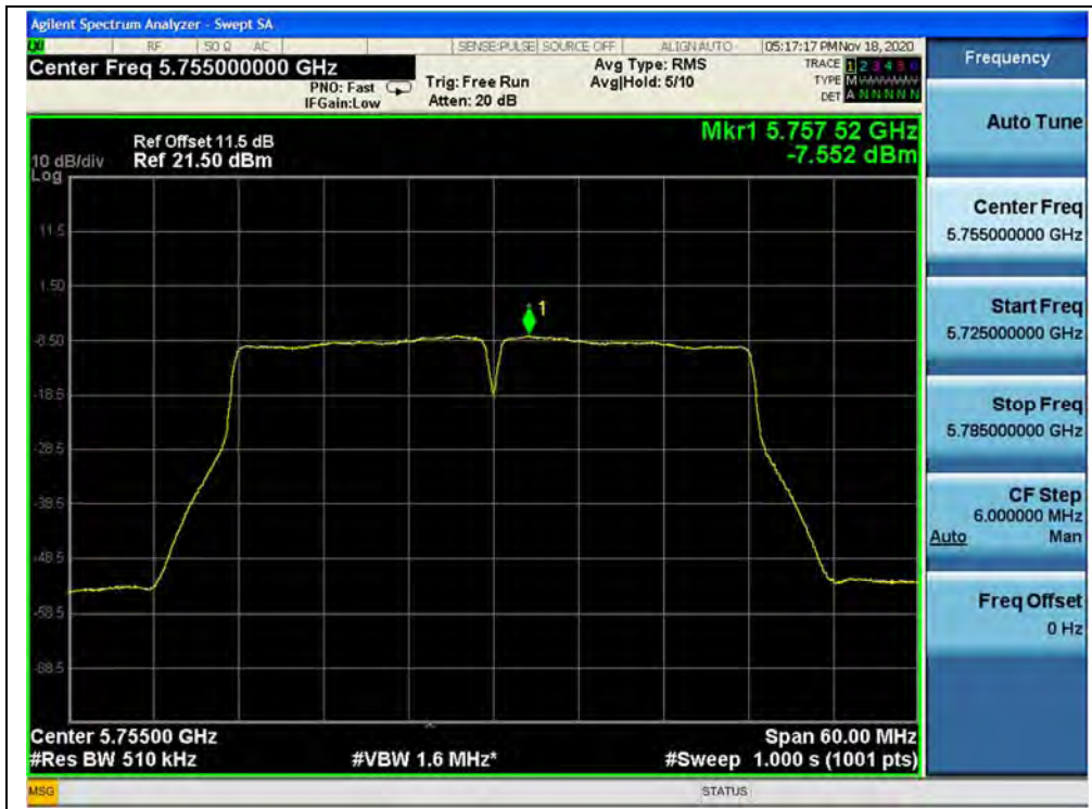
(Channel 151, 5755MHz, 802.11ac (VHT40), ANT1)
