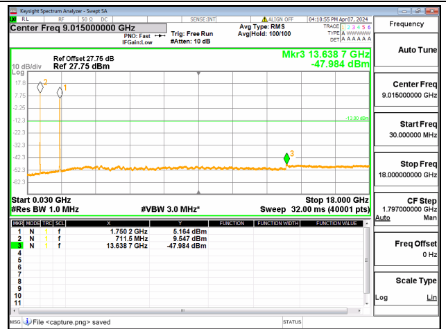
12A-66A / 10+20MHz / QPSK / High+Mid CH / 50@0-100@0
