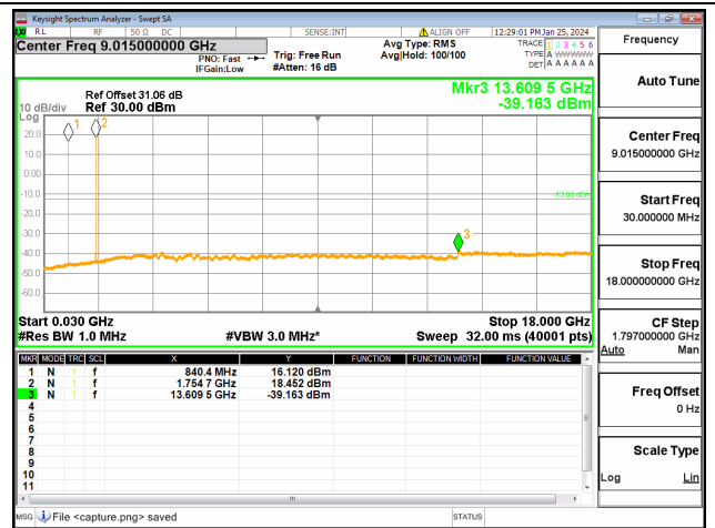
4A-5A / 20+10MHz / QPSK / High+High CH / 1@99-1@0
