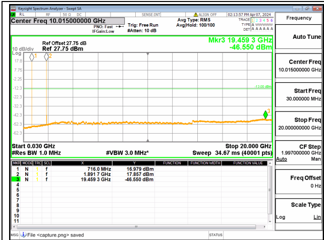
2A-12A / 20+10MHz / QPSK / High+High CH / 1@0-1@49
