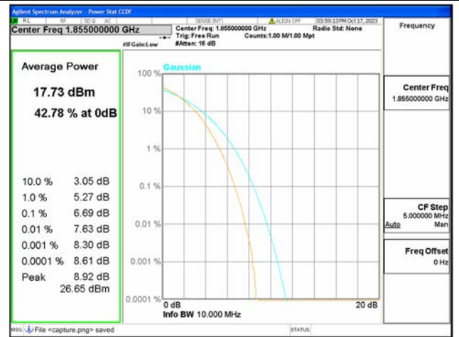
B2 / 10MHz / Low CH / 256QAM
