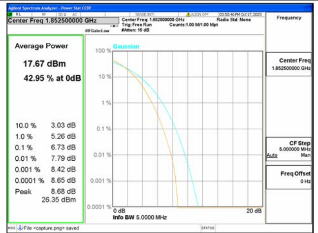
B2 / 5MHz / Low CH / 256QAM
