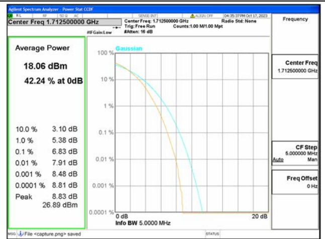
B4 / 5MHz / Low CH / 256QAM
