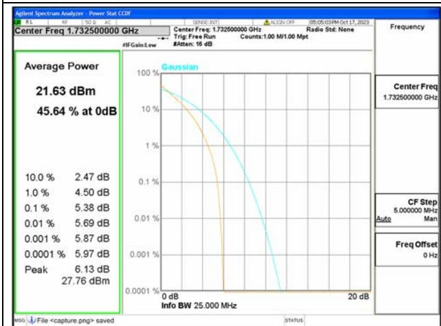
B4 / 20MHz / Mid CH / QPSK
