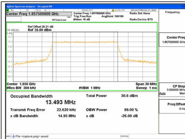
B2 / 15MHz / QPSK/ Low CH
