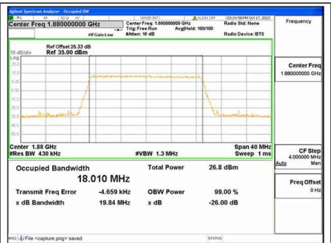
B2 / 20MHz / 256QAM/ Mid CH
