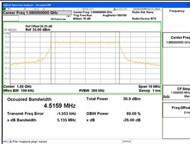
B2 / 5MHz / QPSK/ Mid CH
