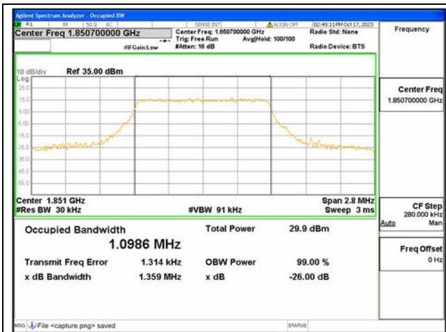
B2 / 1.4MHz / QPSK/ Low CH
