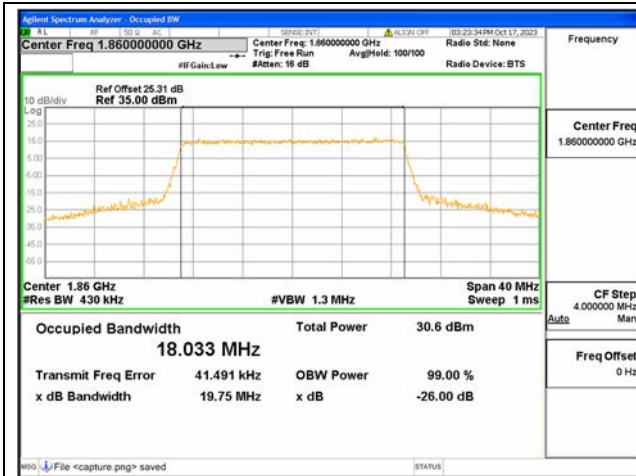
B2 / 20MHz / QPSK/ Low CH
