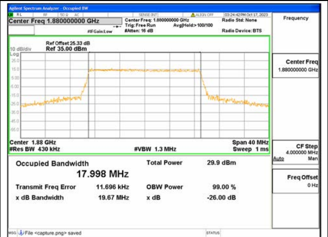
B2 / 20MHz / 16QAM/ Mid CH
