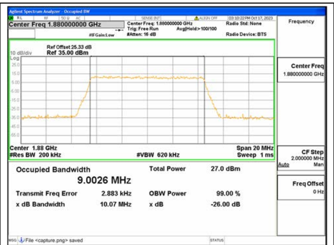
B2 / 10MHz / 256QAM/ Mid CH
