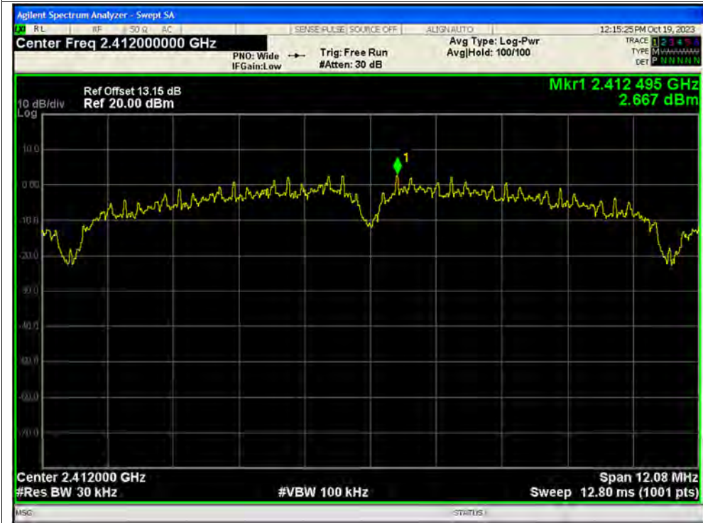
PSD NVNT b 2437MHz Ant1 SISO
