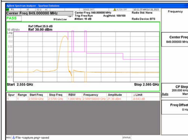
B7 / 15MHz / High CH / QPSK / 1 RB
