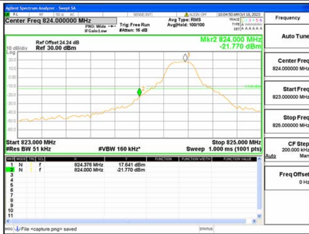
B5 / 5MHz / Low CH / QPSK / 1 RB
