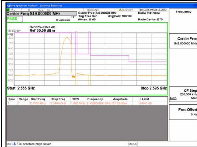
B7 / 20MHz / High CH / QPSK / 1 RB
