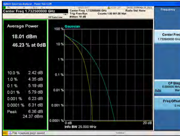
Band4 / 20MHz / Mid CH / 64QAM
