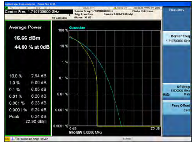
Band4 / 1.4MHz / Mid CH / QPSK
