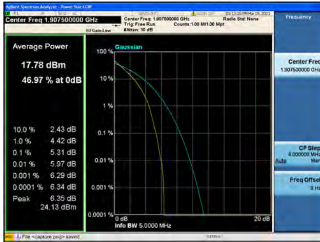
Band2 / 5MHz / High CH / 64QAM
