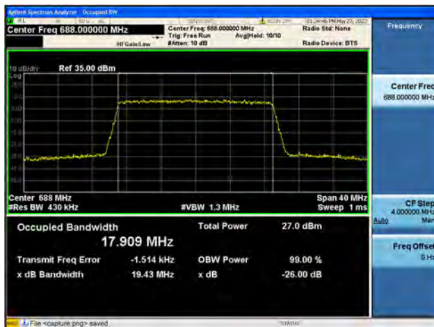
Band71 / 20MHz / High CH / 16QAM
