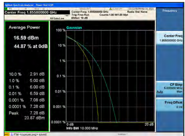
Band2 / 10MHz / Low CH / 64QAM
