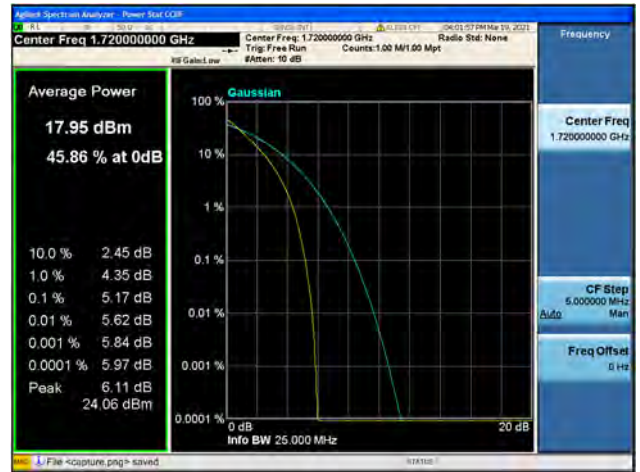
Band4 / 20MHz / Low CH / 64QAM
