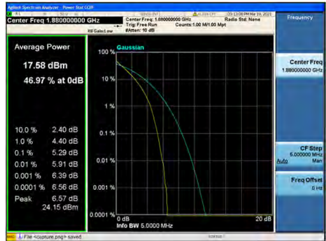
Band2 / 5MHz / Mid CH / 64QAM
