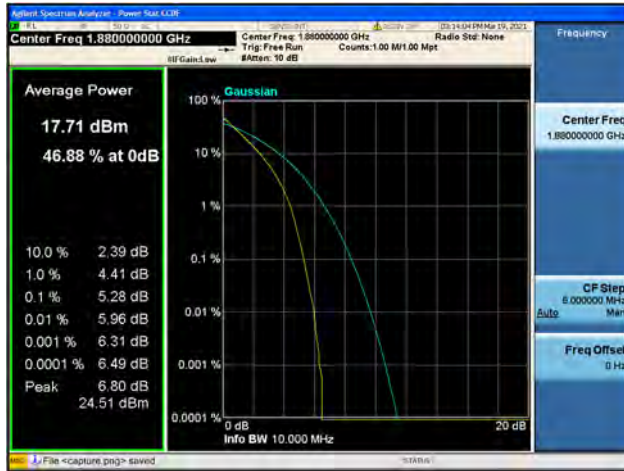
Band2 / 10MHz / Mid CH / 64QAM
