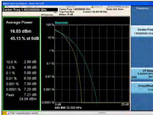
Band2 / 20MHz / Low CH / 16QAM
