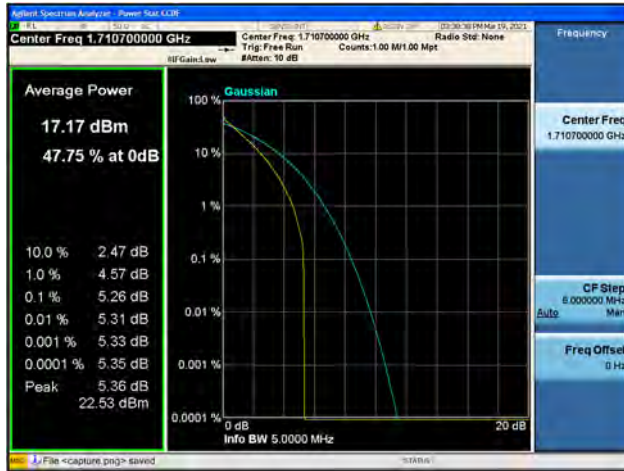
Band4 / 1.4MHz / Low CH / 64QAM
