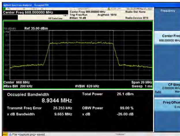
Band71 / 10MHz / Low CH / 16QAM
