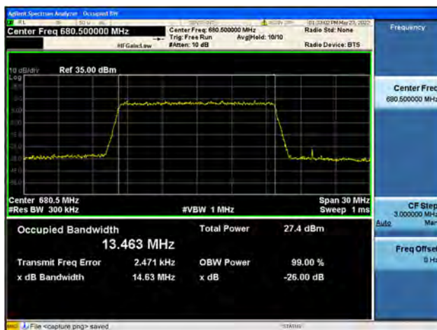
Band71 / 15MHz / Mid CH / 16QAM
