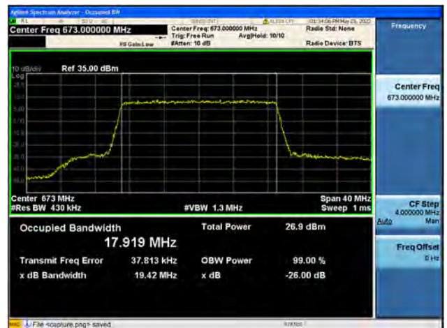
Band71 / 20MHz / Low CH / 64QAM
