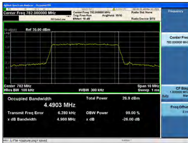
Band13 / 5MHz / Mid CH / 16QAM
