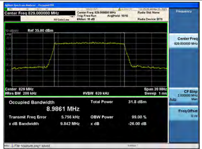
Band5 / 10MHz / QPSK/ Low CH
