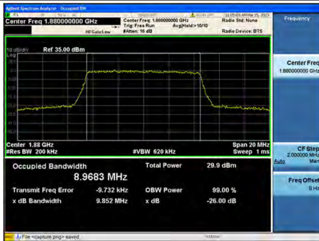
Band2 / 10MHz / 64QAM/ Mid CH
