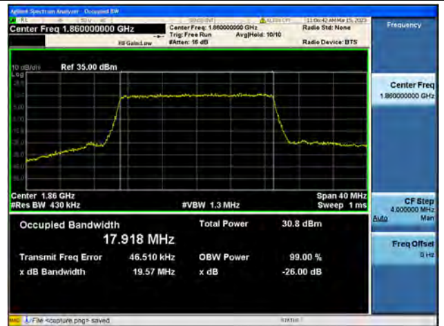
Band2 / 20MHz / QPSK/ Low CH
