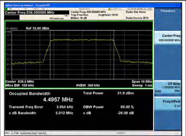
Band5 / 5MHz / QPSK/ Mid CH
