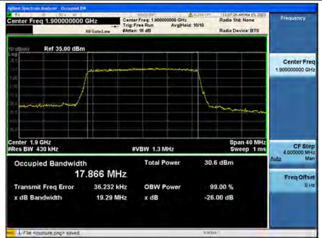
Band2 / 20MHz / QPSK/ High CH
