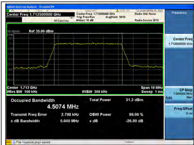
Band4 / 5MHz / QPSK/ Low CH
