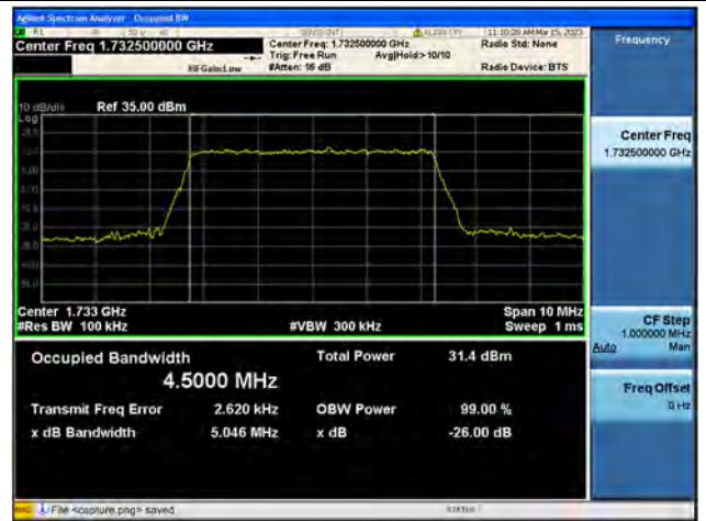
Band4 / 5MHz / QPSK/ Mid CH
