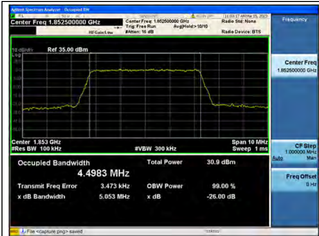
Band2 / 5MHz / QPSK/ Low CH
