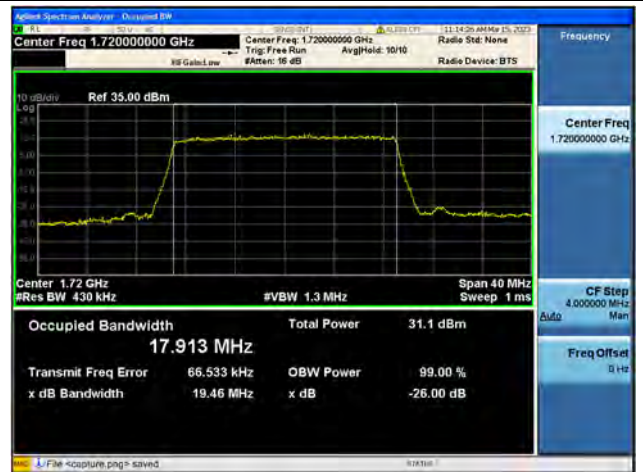
Band4 / 20MHz / QPSK/ Low CH
