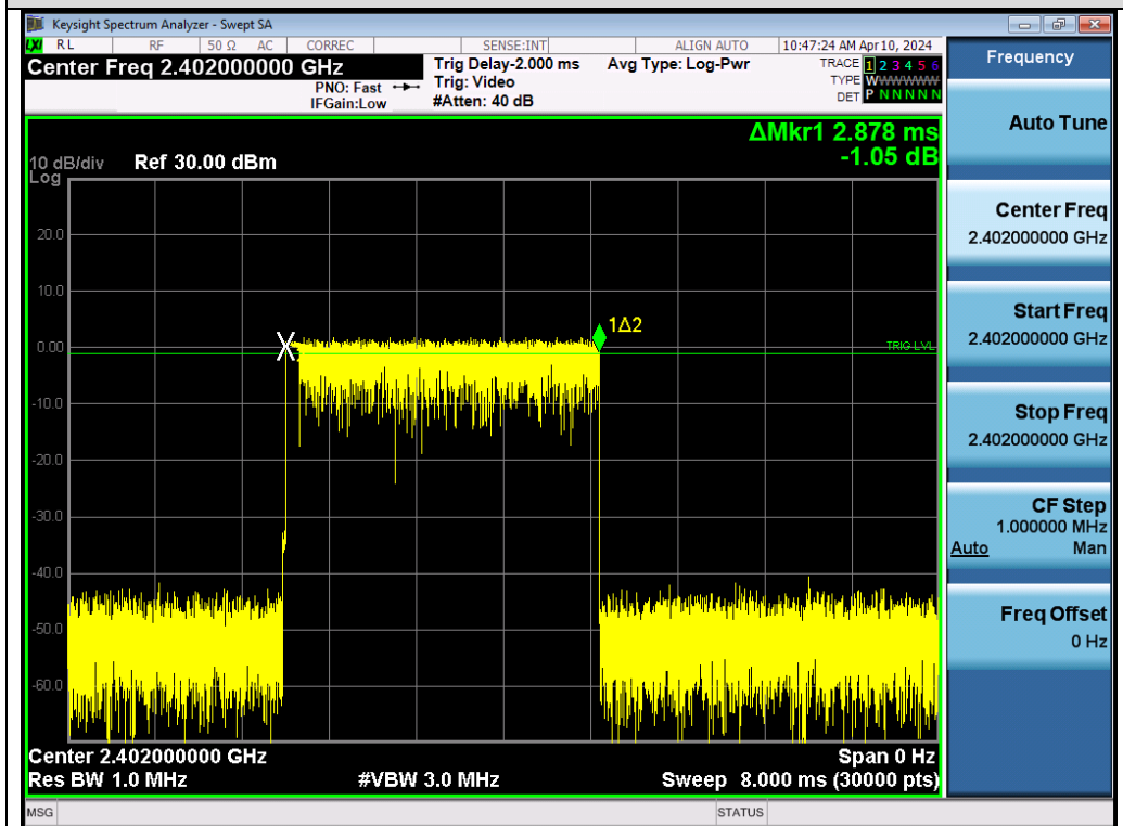
Test_Graph_EDR_HOP_ANT1_NA_3Mbps_2402_Time per Burst
