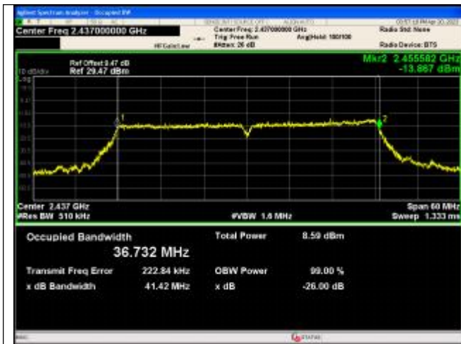
IEEE 802.11n_Channel 6_40MHz_Antenna 0
