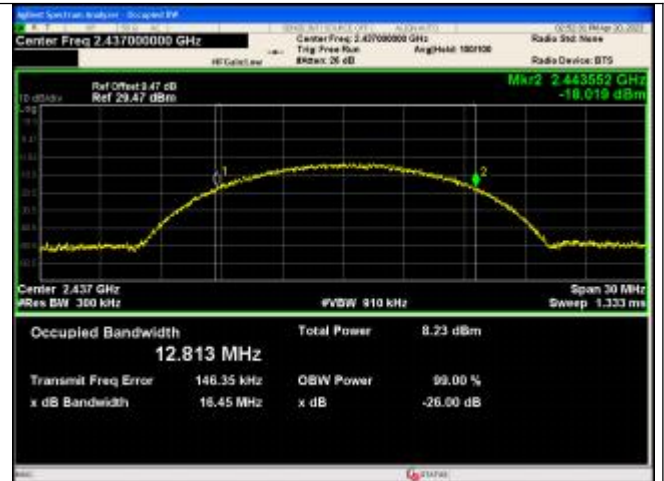
IEEE 802.11b_Channel 6_20MHz_Antenna 0
