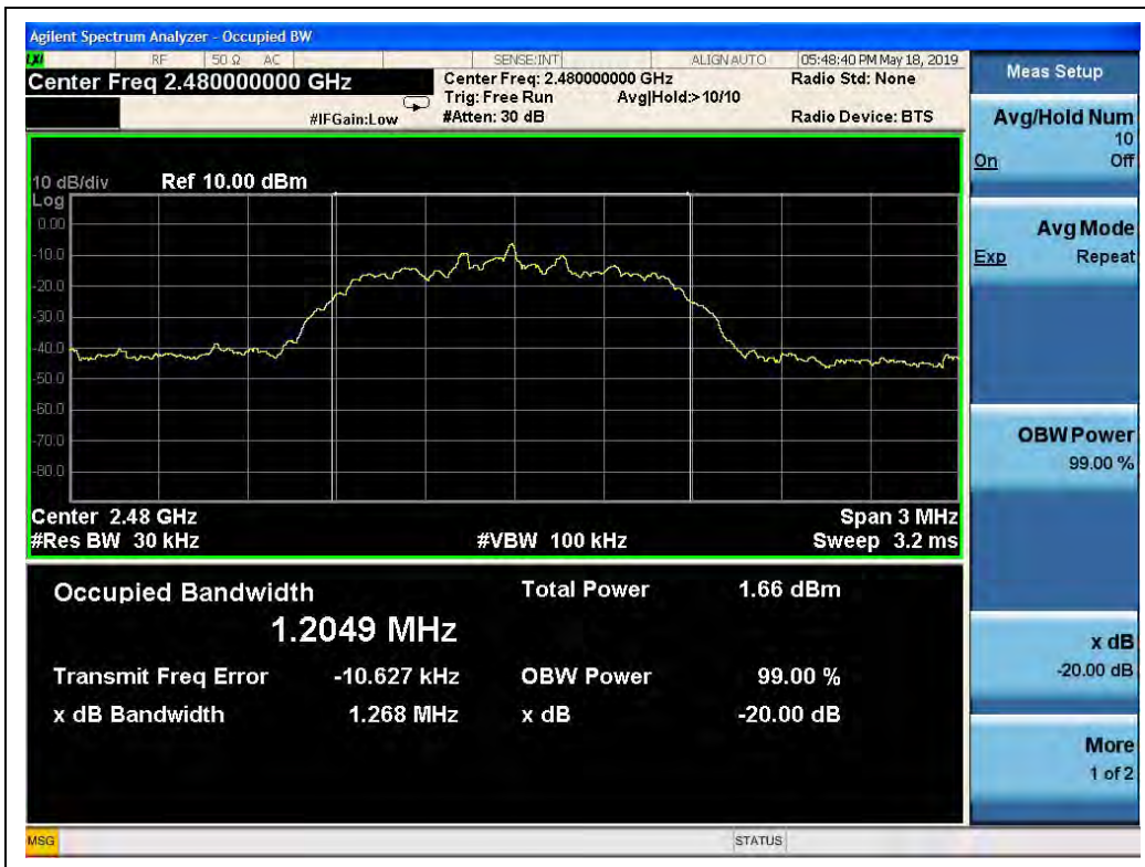
( \pi/4 -DQPSK, Channel 78, 2480MHz)
