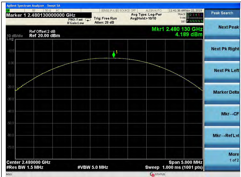
( \pi/4 -DQPSK, Channel 78, 2480MHz)
