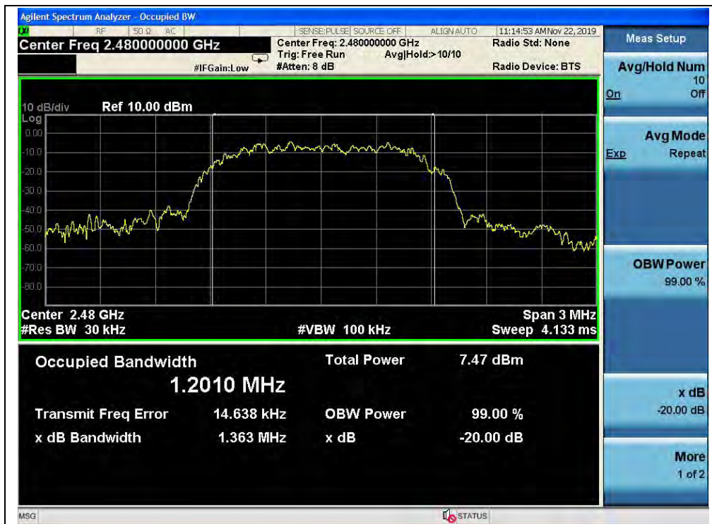
( \pi/4 -DQPSK, Channel 78, 2480MHz)
